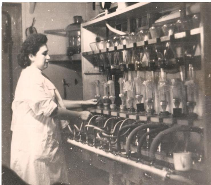
*Рис. 21. Фильтровальная установка в лаборатории геологии моря
