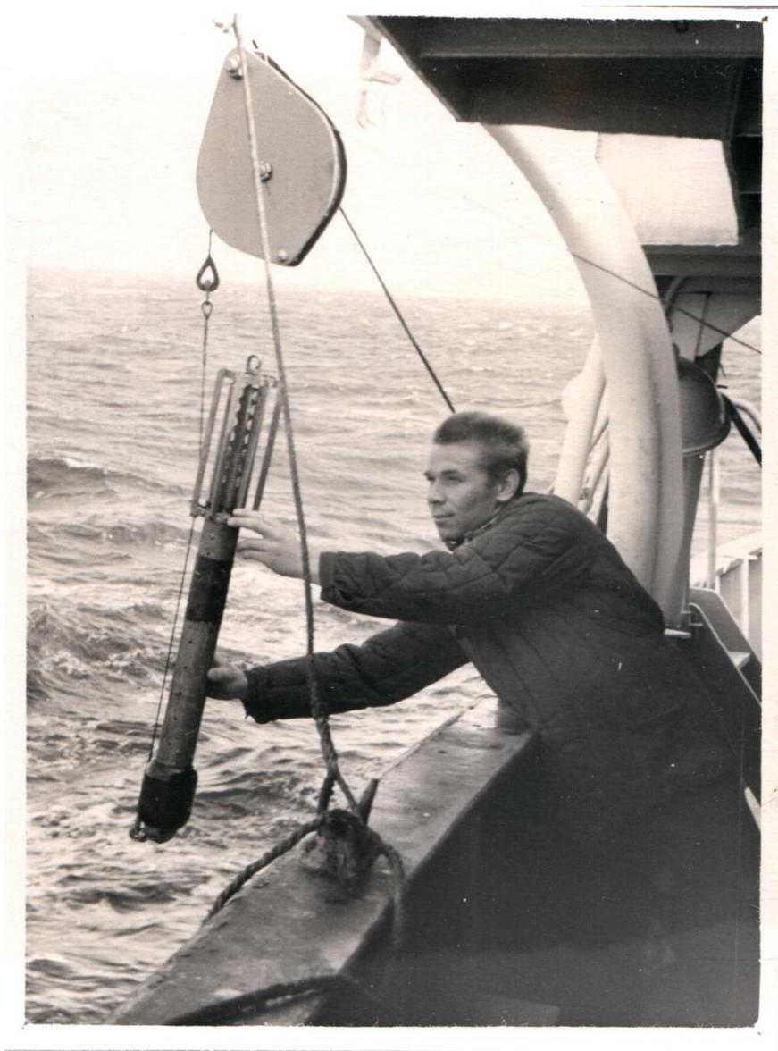
*Рис. 26. Пуск батитермографа на ходу судна
