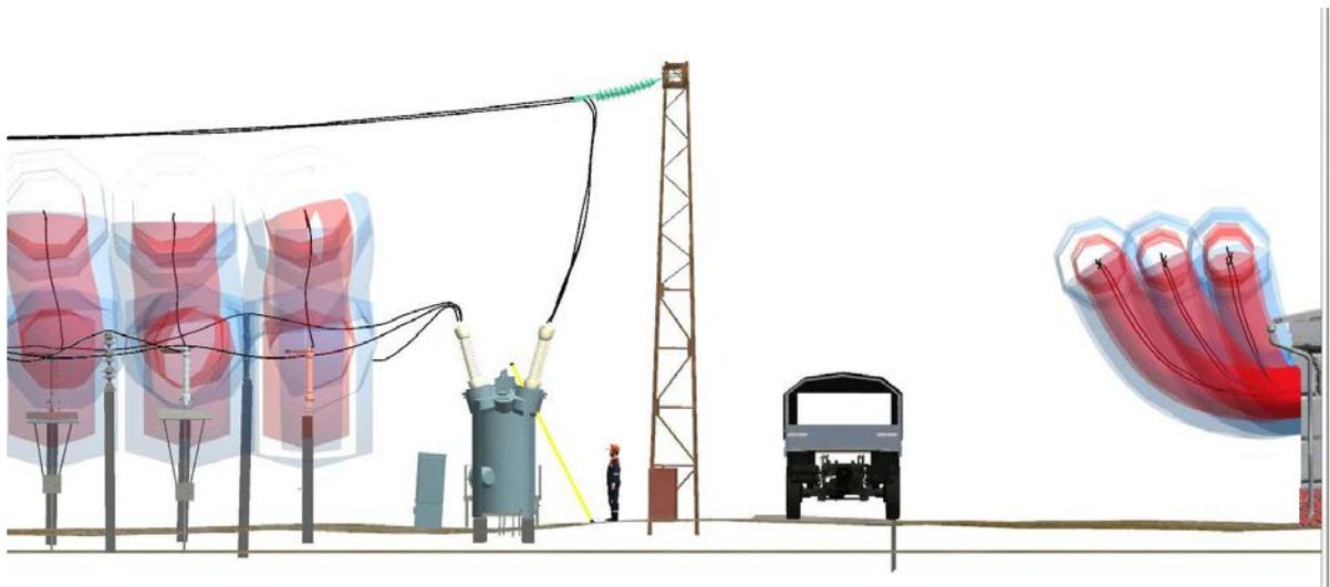
Рисунок 3.41 — Ортографическая проекция части 3D-модели для составления плана производства работ (ППР).
