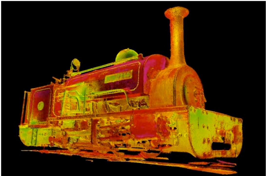
Рисунок 1.9 — Локомотив Winifred. Точечная 3D-модель (результат лазерного сканирования). Изображение из Интернета.
