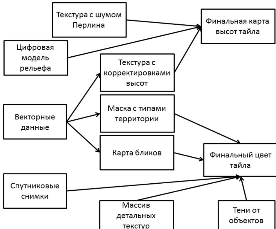
Рисунок 3.60 — Схема потоков данных при процедурной генерации объектов на виртуальном глобусе
