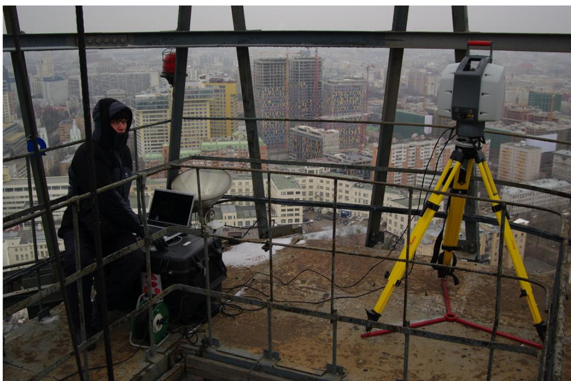
Рисунок 2.2 — Лазерное сканирование Шуховской башни, отметка 125 м (стык 5 и 6 секций)
