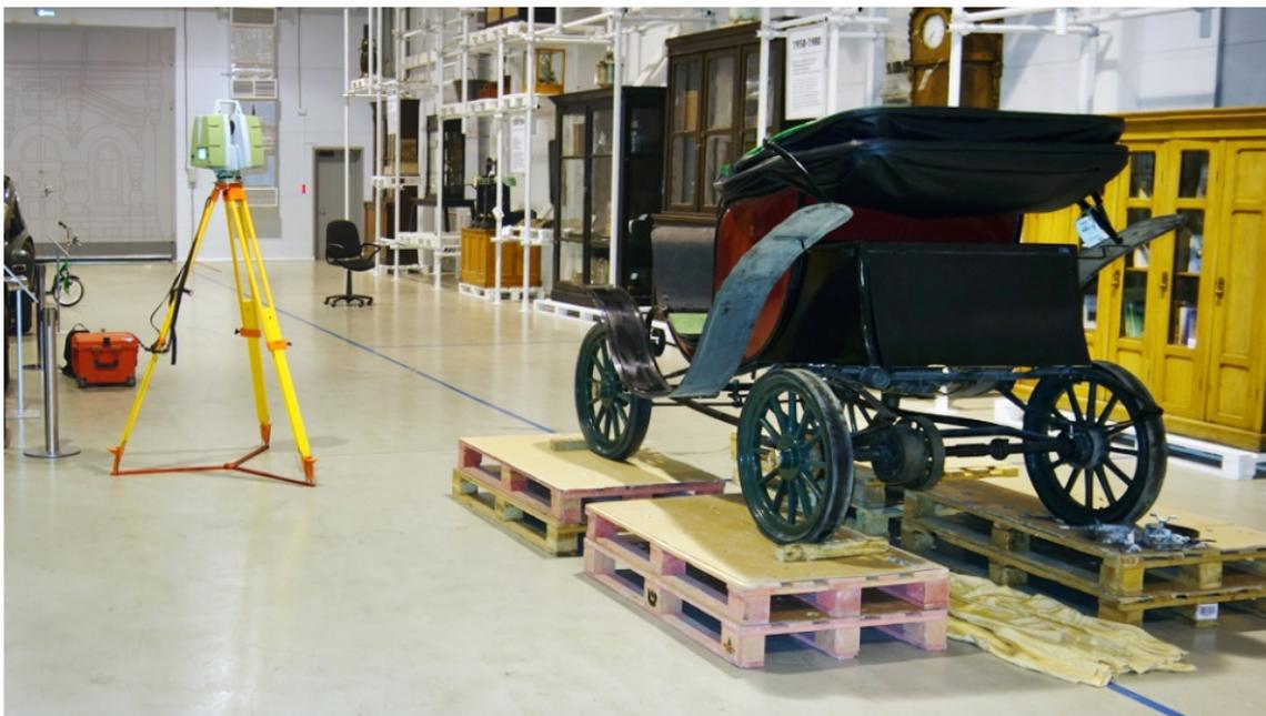
Рисунок 2.35 — Выполнение лазерного сканирования электромобиля
