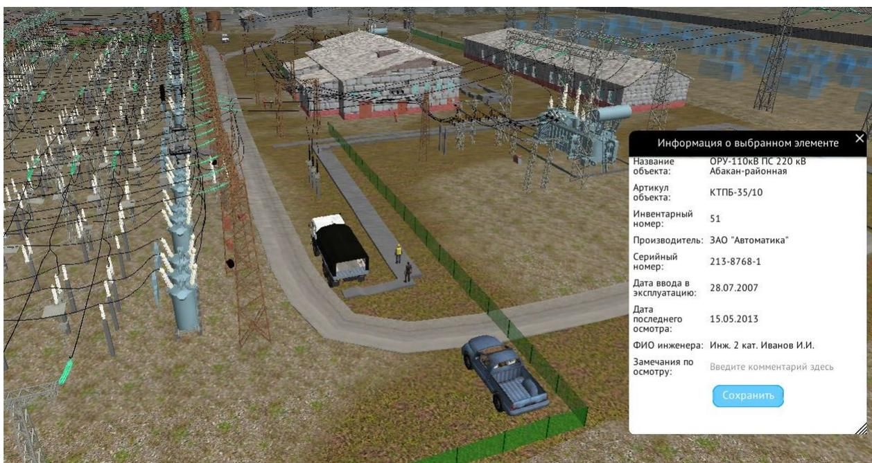
Рисунок 3.38 — Вывод атрибутивной информации о выбранном элементе виртуальной 3D-модели подстанции
