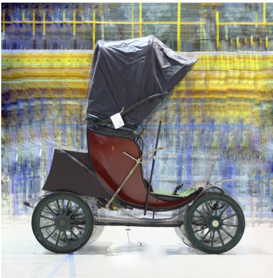
Рисунок 2.34 — Ортофотоплан электромобиля, созданный из серии фотографий, отснятых параллельно плоскости проекции
