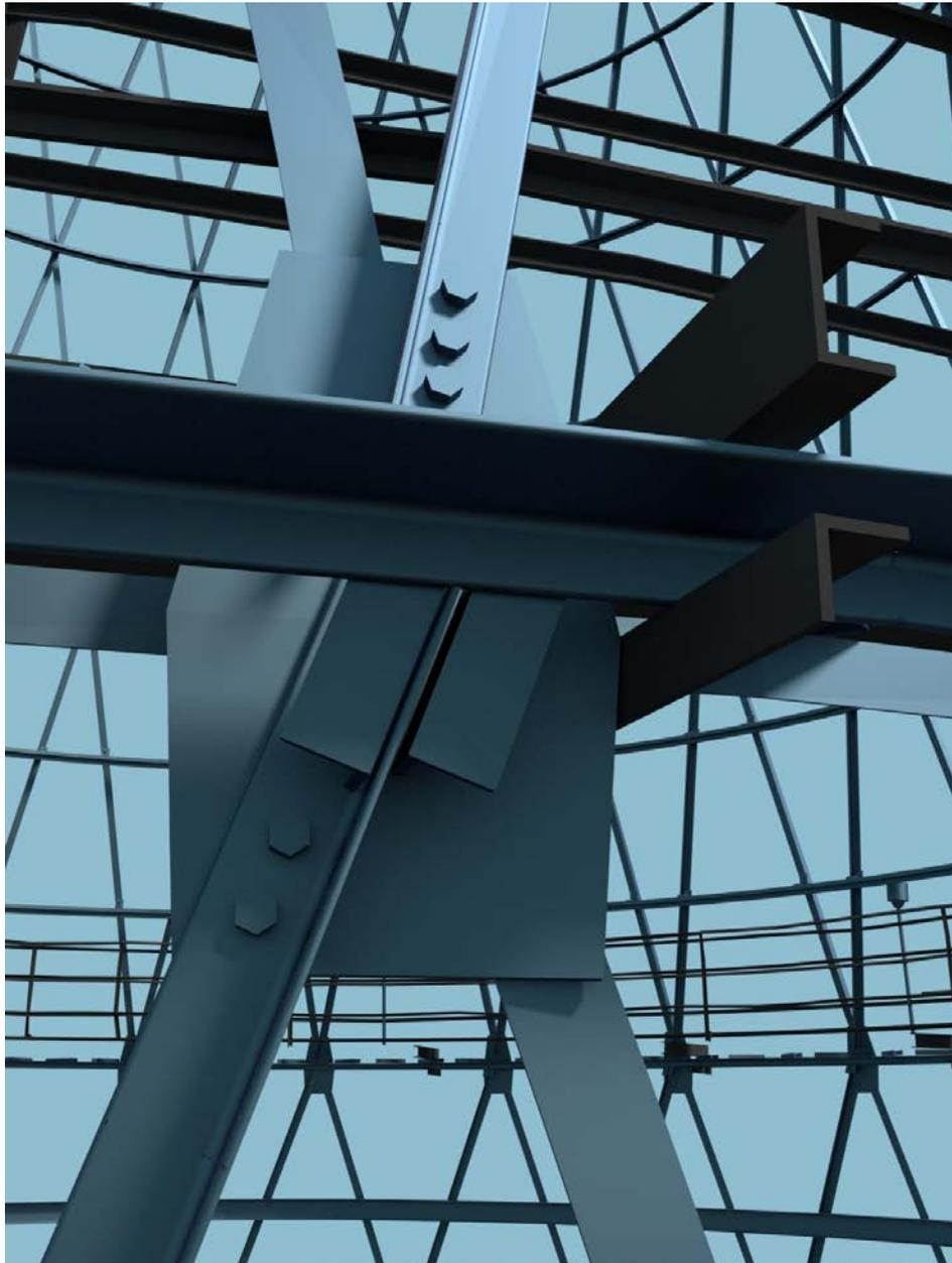
Рисунок 2.12 — 3D-модель башни, стык 3 и 4 секций,
