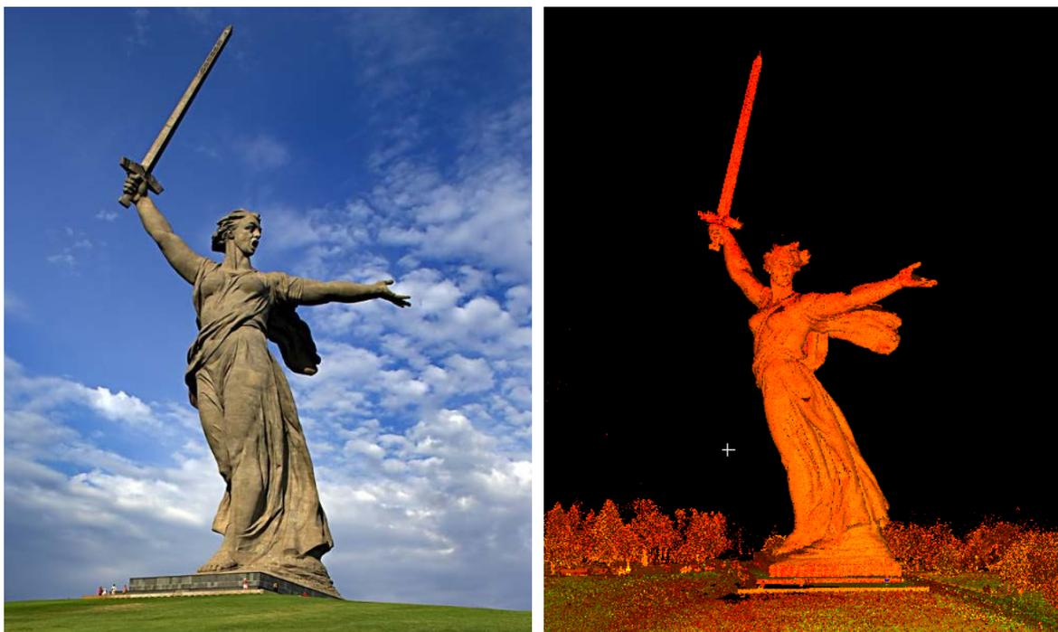
Рисунок 2.51 — Точечная трехмерная модель скульптуры «Родина-Мать зовет!», полученная в результате лазерного сканирования (справа), фотография с похожего ракурса (слева, фото из интернета).
