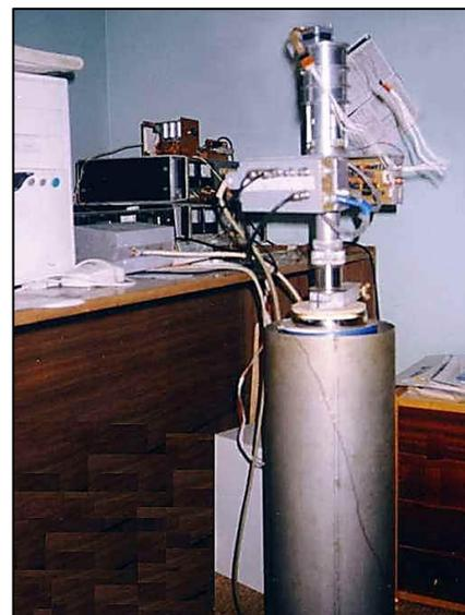
**Рис. 1. Сканирующий СКВИД-микроскоп**
