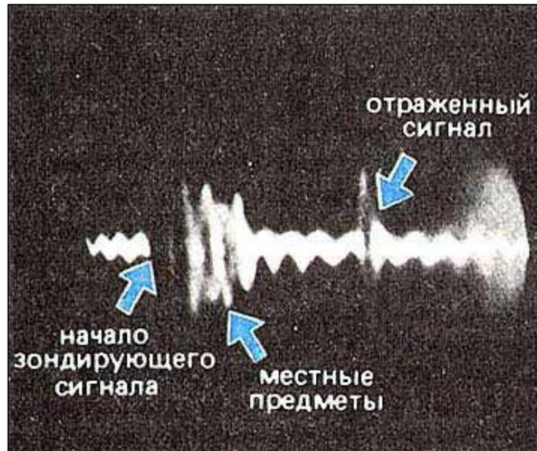
Рис. 31п. Фото с экрана осциллографа в опытах 1938 г.
