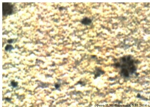
Рис. 3. Останцы обвальной брекчии над стенкой карьера и микрофотография среза бешеной муки”, линейное увеличение 80 крат. Светлые бесструктурные скопления – «бешеная мука», более темные углубления – микропоры, красное – гидроокислы железа, темное – вулканическое стекло и мельниковит (?). Снимок выполнен методом сканирования с разрешением 9200 dpi [Васьков, 2013]
