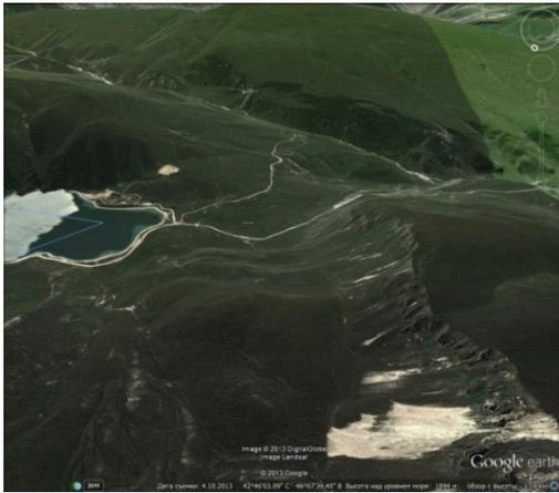
Рис. 6. Завальная плотина озера Казеной-Ам. В теле плотины и на южных склонах (эскарпах), сложенных карбонатными породами, хорошо видны осыпи и обрывы ярко белого цвета, характерные для проявлений катастрофических обвалов в известняках.
