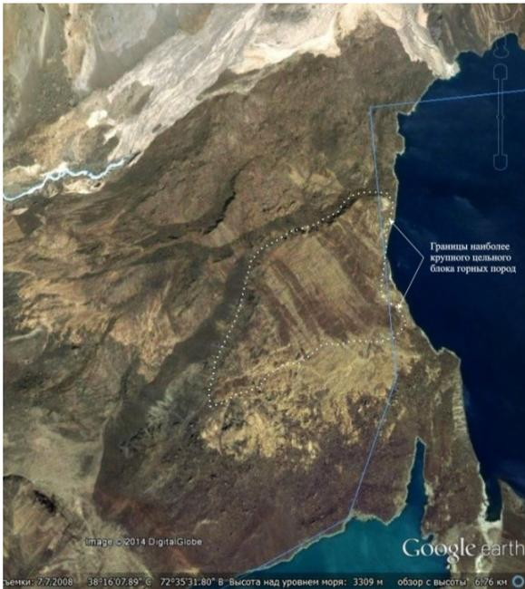
Рис. 11. Крупная цельная глыба горных пород в теле Усойского завала размерами 1,5×0,8 км. Выделяется по отчетливой линзовидно-ленточной полосчатости, обрывистой стенке с ЗСЗ стороны, а также положительной аномалией силы тяжести. Ряд глыб меньших размеров, расположенных севернее, образуют гребни, диагональные к продольной оси завала. Их положение также отмечается положительными гравиметрическими аномалиями
