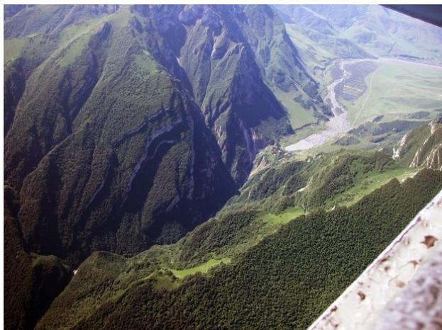
Рис. 4. По центру снимка гребень естественной плотины (завал «Пурт») на котором видны здания турбазы «Кахтысар». В нижнем бьефе плотины – каньон р. Гизельдон, в верхнем – водохранилище Гизельдонской ГЭС и аккумулятивная долина на месте подпрудного озера. По правому борту долины видны фрагменты абразионных террас, наиболее чёткая в районе с. Даргавс в правом верхнем углу.
