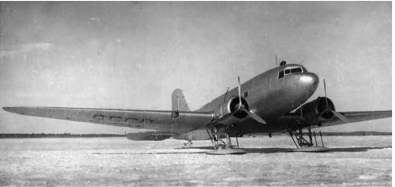
Один из первых ПС-84 на лыжном шасси, 1939 год. Отсутствуют коки винтов и лобовые капоты моторов—это характерная черта машин ранних выпусков
