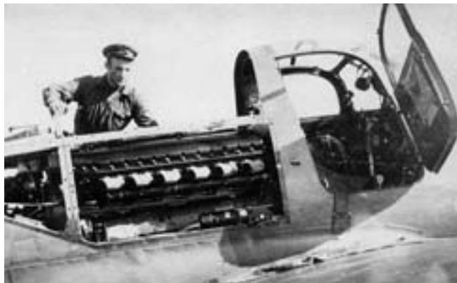
**Механик осматривает мотор «Аэрокобры»**
