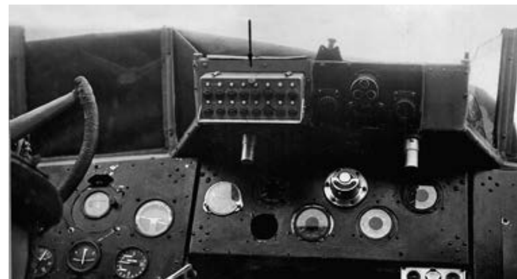
Кнопочный пульт управления в кабине ТБ-3
