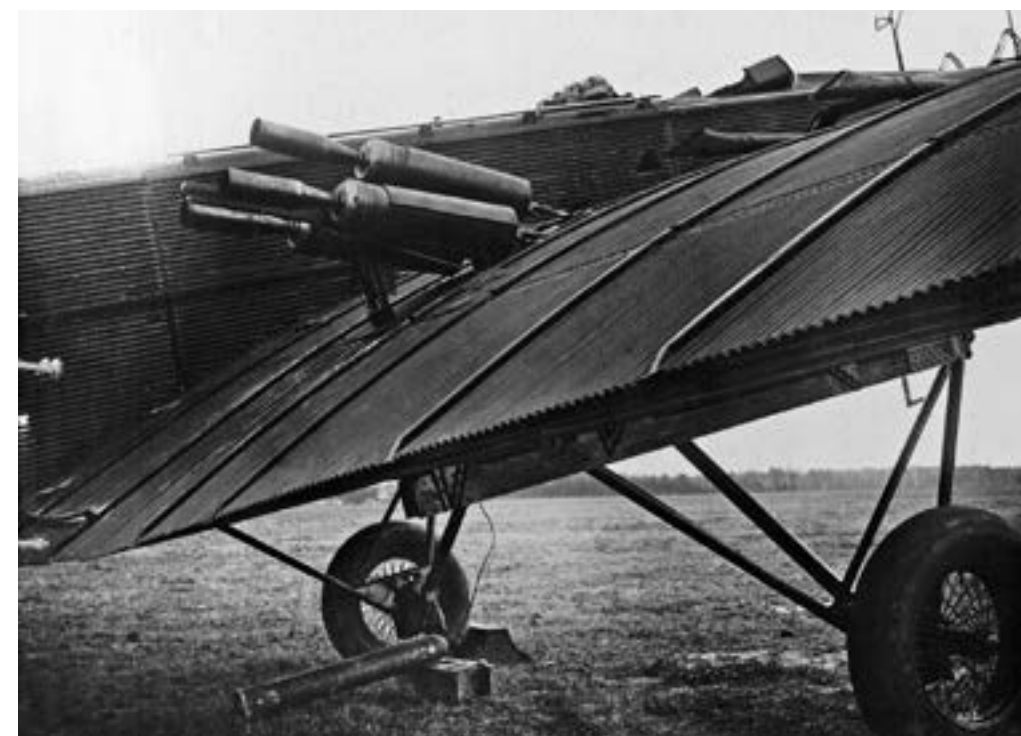
Новая компоновка ускорителей на ТБ-1. 1933 г.
