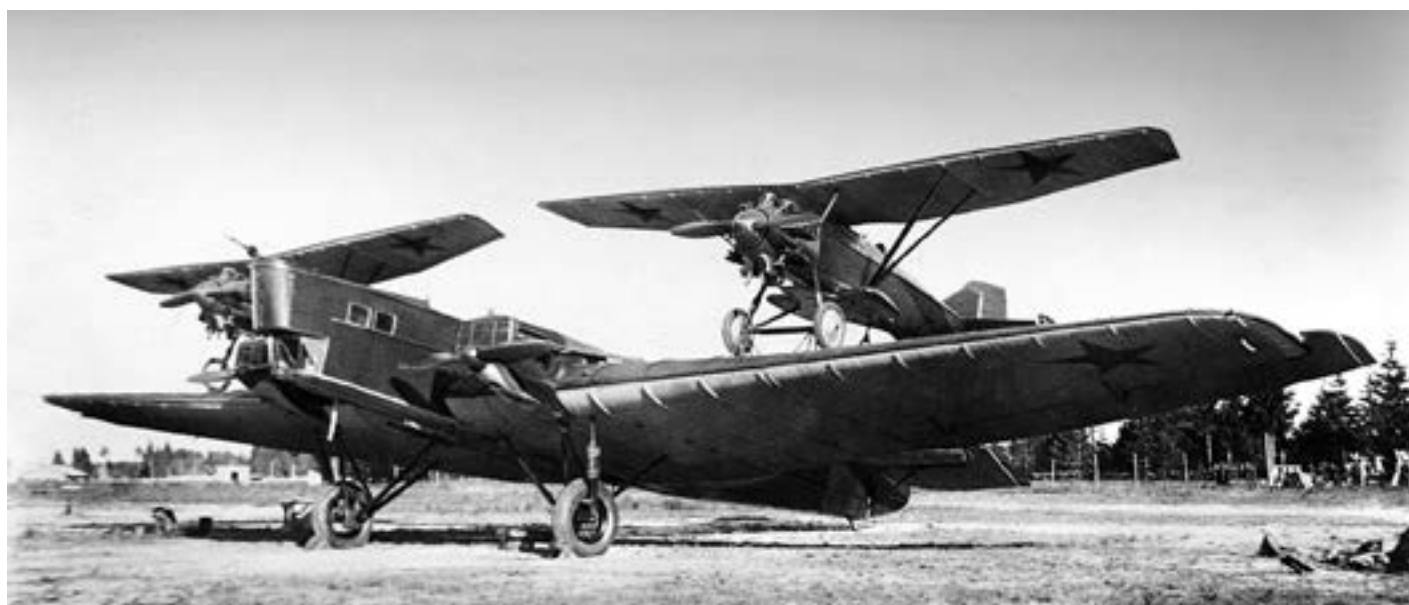
На государственных испытаниях, 1932 г. Видны дополнительные (внешние) стойки шасси ТБ-1
