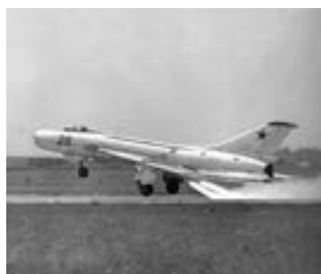
Истребитель Су-7 со сбрасываемыми стартовыми ракетными ускорителями
