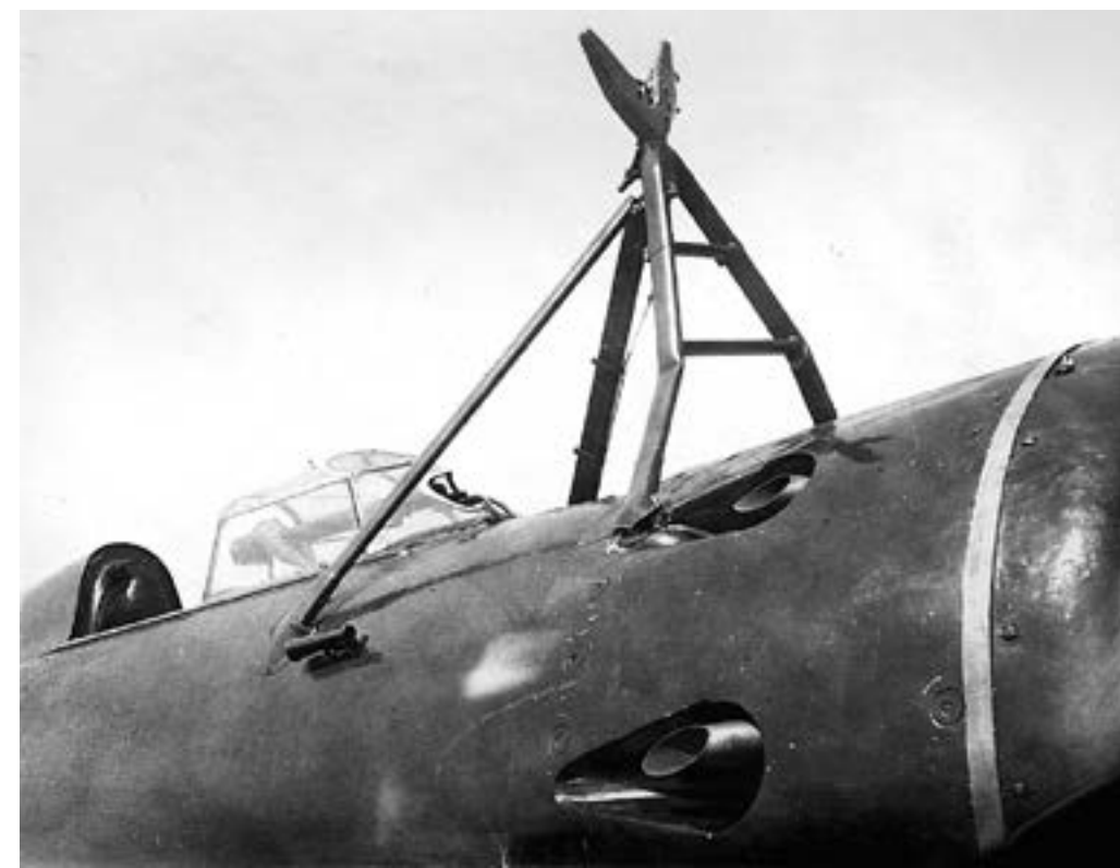
Деформация фермы замка из-за удара при подцепке
