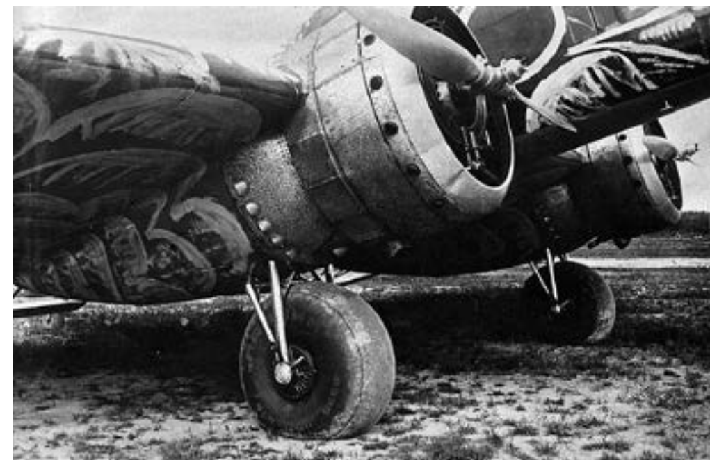
Большие неубирающиеся колеса сильно портили аэродинамику самолёта
