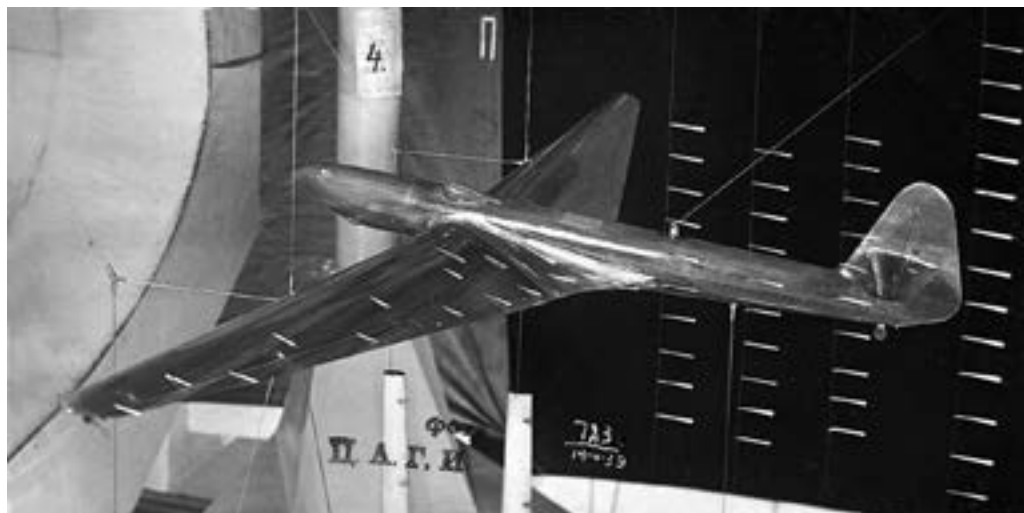
Модель самолёта БОК-15 в аэродинамической трубе ЦАГИ, 1939 г.
