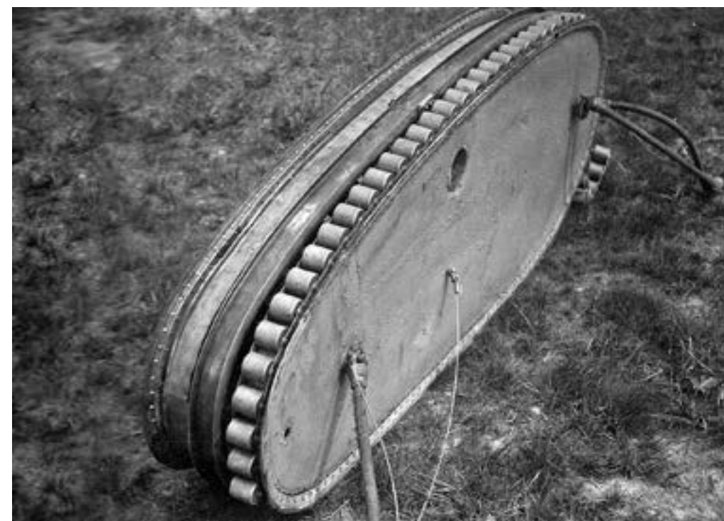
Конструкция шасси самолета П-5 со снятой гусеницей
