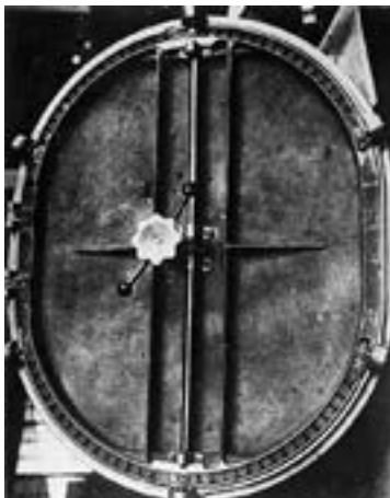
Входной герметичный люк кабины
