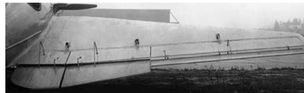
Поворотная часть крыла и рулевые поверхности
