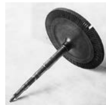
Турбина компрессора с оборванной лопаткой
