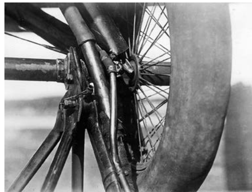
Трубки бензо- и маслопитания И-5 из баков самолёта-носителя
