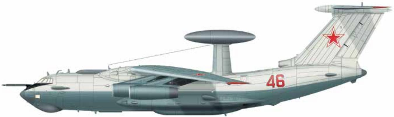
Самолет дальнего радиолокационного обнаружения, разработан на базе транспортного Ил-76МД. А-50 строили силами двух заводов: в Ташкенте создавали сам самолет, а на Таганрогском авиапроизводственном объединении на него устанавливали радиолокатор в обтекателе над
