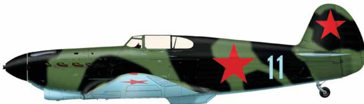
Первый массовый боевой самолет ОКБ А.С. Яковлева, одноместный истребитель смешанной конструкции с двигателем водяного охлаждения. Достоинствами самолета были малый вес конструкции, технологичность, простота в управлении, хорошие летные характеристики. Особенности двигателя позволяли расположить пушку в развале цилиндров и вести огонь через ось пропеллера, что повышало точность стрельбы.
