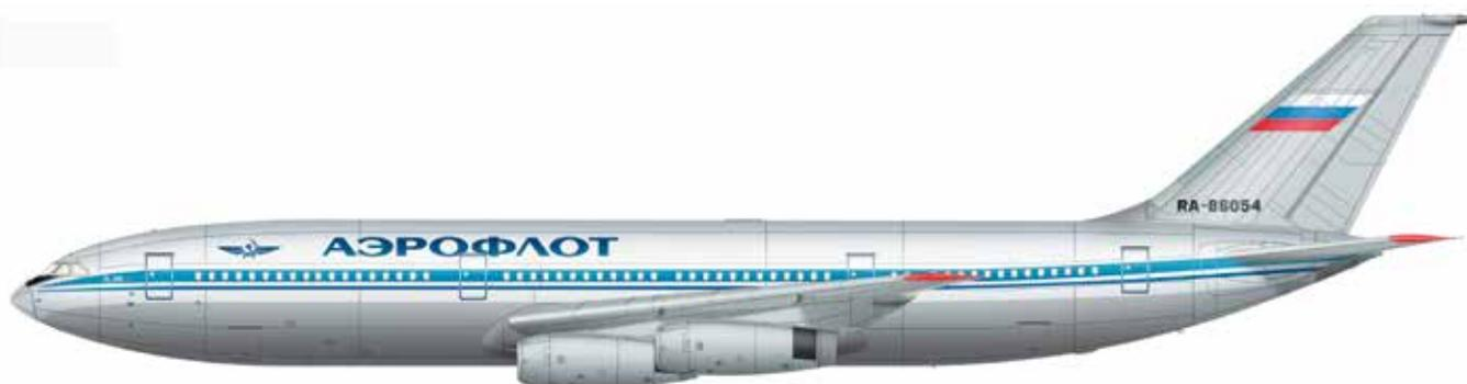
Первый в СССР широкофюзеляжный пассажирский самолет. Это был также первый отечественный авиалайнер с двигателями на пилонах под крылом. Самолет мог перевозить за один рейс рекордное для «Аэрофлота» число пассажиров — 350 человек. Его эксплуатация на воздушных линиях началась в 1980 г., сертификат типа получен 24.12.1980 г. Наибольшую эффективность Ил-86 показал на маршрутах средней протяженности с большими пассажиропотоками, например, Москва-Сочи.
