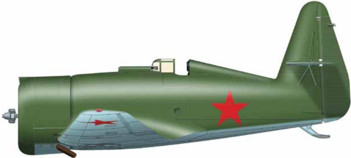
Одноместный самолет конструкции П.О. Сухого, первый в СССР металлический истребитель со свободнонесущим крылом и убирающимся шасси. На заводе в Иркутске велась постройка 55 И-14, но закончили и сдали только 18. Производство было прекращено из-за плохих штопорных характеристик истребителя и отказа от применения на самолетах крупнокалиберных пушек ДРП, под которые проектировалась данная машина.
