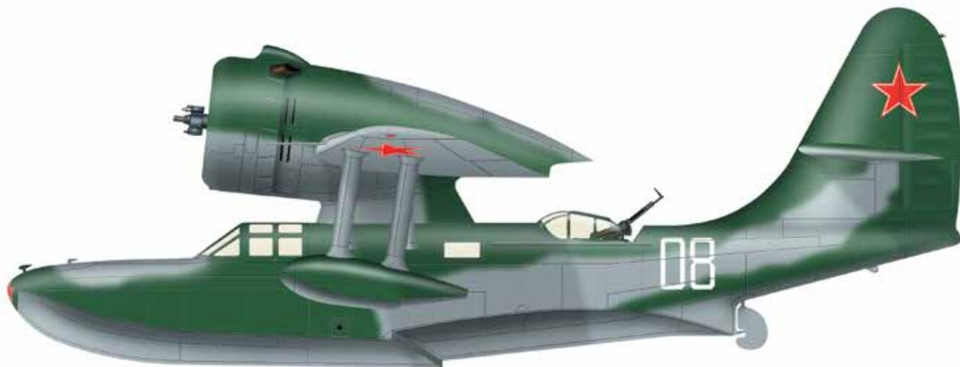
Корабельный катапультный разведчик и легкий бомбардировщик, создан на замену КОР-1. Металлический моноплан-летающая лодка с крылом типа «обратная чайка». Были на вооружении Балтийского, Черноморского и Тихоокеанского флотов. Применялись также для боевого патрулирования северного побережья СССР.
