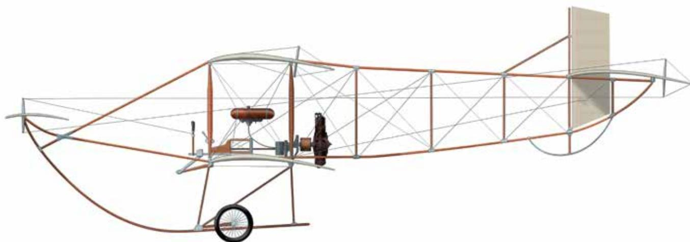
Двухместный французский самолет конструкции Р. Соммера. Деревянный бесфюзеляжный биплан с полотняной обшивкой крыла и крестообразным хвостовым оперением. Руль высоты расположен перед крылом на изогнутых брусках, являющихся продолжением ползьев шасси. Угол установки хвостового горизонтального оперения можно было менять в полете. Для удобства транспортировки предусмотрена возможность складывания хвостовой фермы и балок крепления руля высоты вбок параллельно крылу.
