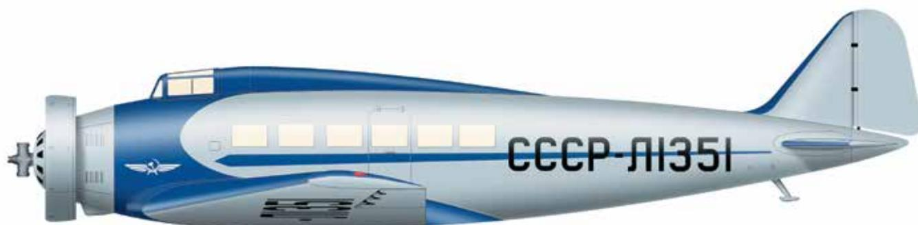
Первый в СССР самолет с убирающимся шасси. Сконструирован под руководством И.Г. Немана в Харьковском авиационном институте в 1932 г. Самолет имел обтекаемый монококовый фюзеляж из шпона (многослойной фанеры), крыло свобод-нонесущее. Благодаря хорошим аэродинамиче-ским формам в момент появления ХАИ-1 являлся самым скоростным в Европе пассажирским само-летом. Наряду с пассажирским строили военный вариант ХАИ-ВВ — двухместный бомбардиро-щик.
