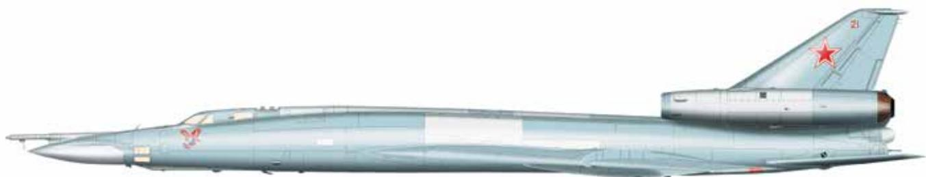
Дальний бомбардировщик, первый в СССР тяжёлый сверхзвуковой самолет. Создан для замены бомбардировщика Ту-16. В связи с большим количеством доработок официально принят на вооружение только в 1968 г., и построили Ту-22 значительно меньше, чем Ту-16. Выпускался в вариантах: бомбардировщик Ту-22, разведчик Ту-22Р, ракетоносец Ту-22К, постановщик помех Ту-22П, учебно-тренировочный Ту-22У. В 90-е гг. Ту-22 были выведены из состава ВВС России.
