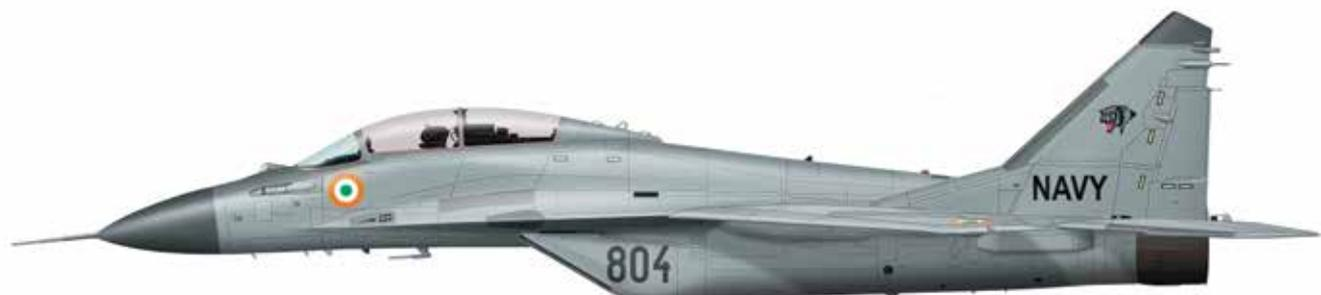
Одноместный корабельный истребитель четвертого поколения. Разработан на базе самолета МиГ-35 в РСК «МиГ» для базирования на тяжелых авианесущих крейсерах с трамплинным взлетом и аэрофинишной посадкой. Имеет складывающиеся консоли крыла для уменьшения габаритов самолетов в ангарах корабля. Строится также двухместная учебно-боевая модификация — МиГ-29КУБ. Самолеты экспортируются в Индию.
