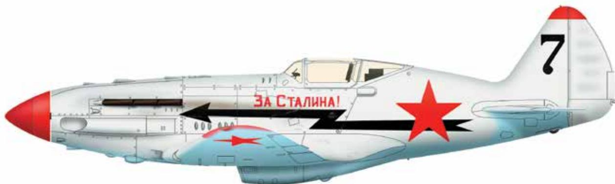
Самый скоростной советский истребитель начального периода Великой Отечественной войны. Сконструирован под руководством А.И. Микояна и М.И. Гуревича для действий на больших высотах. Самолет смешанной конструкции с самым мощным на тот момент в СССР двигателем водяного охлаждения. Основной серийный вариант МиГ-3 отличался от МиГ-1 увеличенной емкостью топливных баков и улучшенными штопорными характеристиками благодаря установке предкрылков.
