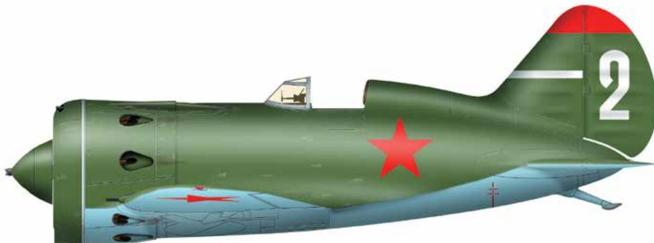
Самый массовый советский боевой самолет довоенного периода. Конструктор — Н.Н. Поликарпов. Это одноместный истребитель смешанной конструкции с убирающимся шасси. Для середины 30-х гг. обладал выдающимися скоростными характеристиками. Имел более 10 модификаций, отличающихся типом моторов и вооружением. 2737 И-16 было выпущено в двухместном учебно-тренировочном варианте.
