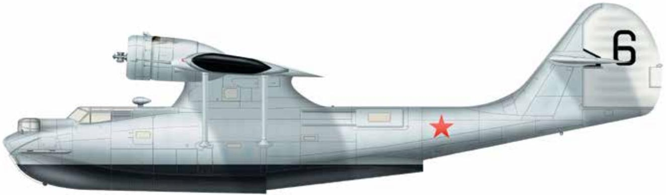
ГСТ («гидросамолет транспортный») – лицензионное воспроизводство американской металлической летающей лодки Консолидейтед РВУ-1. Всего в Таганроге построили 23 ГСТ, сдали — 22. На самолетах устанавливали различные двигатели — Райт «Циклон», М-87, М-88 и М-62. Большинство летающих лодок выпустили в варианте дальнего морского разведчика и бомбардировщика. Пять самолетов предназначались для пассажирских перевозок, они назывались МП-7 и могли брать 20 пассажиров.
