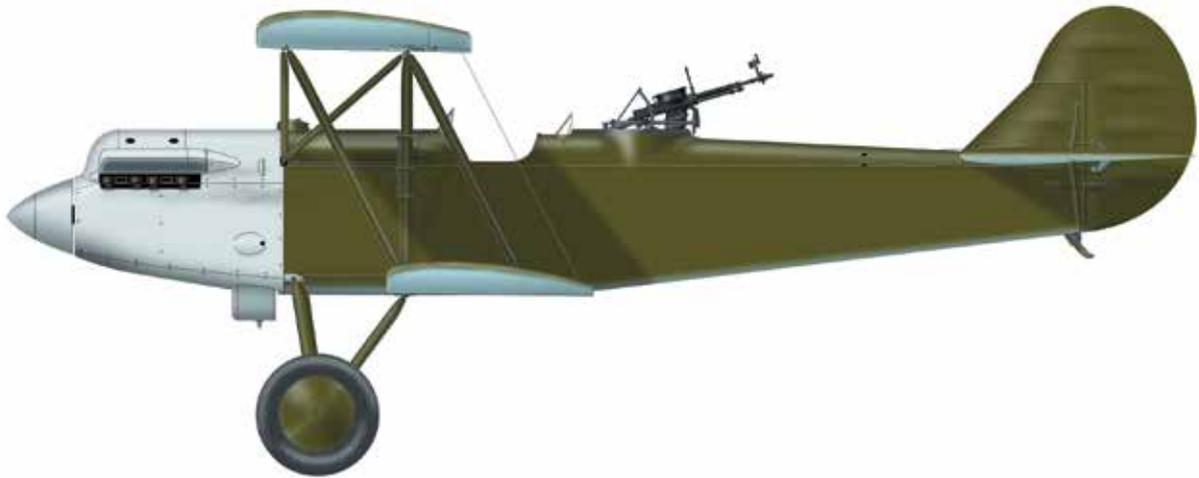
Двухместный «переходный самолет» конструкции Н.Н. Поликарпова. Предназначался для тренировки будущих военных летчиков, прошедших курс первоначального обучения полетам, мог использоваться также как легкий разведчик. Самолет деревянной конструкции, обшивка полотняная. На испытаниях были отмечены опасные штопорные характеристики, плохой обзор из задней кабины. Из 55 построенных машин было сдано 28.
