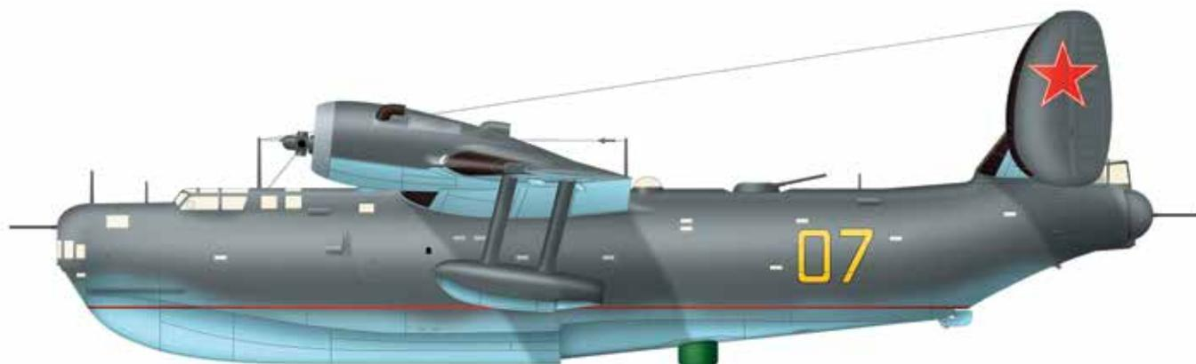
Последняя летающая лодка ОКБ Г.М. Бериева с поршневыми двигателями. Самолет служил в авиации ВМФ для дальней морской разведки, поиска и уничтожения подводных лодок, постановки минных заграждений, для десантных операций и переброски срочных грузов. Бе-6 пробывали на военной службе до конца 60-х гг.
