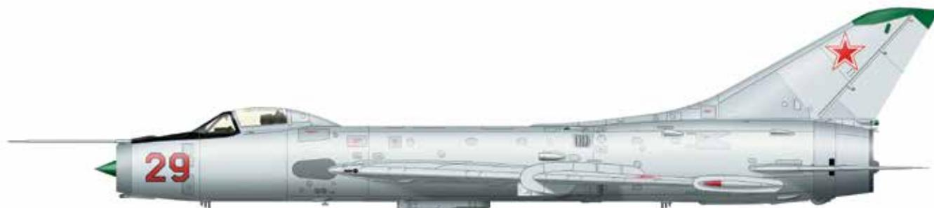
Первый серийный реактивный самолет ОКБ П.О. Сухого. Проектировался одновременно с МиГ-21. Вначале самолет изготавливали в варианте фронтового истребителя, но вскоре по требованию военных он был модифицирован в истребитель-бомбардировщик Су-7Б. В этом предназначении самолет строили 13 лет, основными модификациями были Су-7БМ с увеличенной емкостью баков и Су-7БКЛ с колесно-лыжным шасси. В СССР Су-7Б находился на вооружении до середины 80-х гг.
