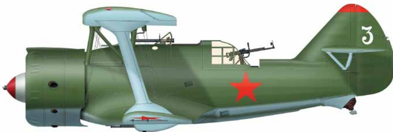
Двухместный истребитель конструкции С.А. Кочеригина и В.Ф. Яценко, первый в СССР биплан с убирающимся шасси. Конструкция смешанная, из стальных труб, дерева и полотна. Кроме основного назначения, самолет выпускали в варианте штурмовика ДИ-6Ш с усиленным вооружением и бронированным сидением летчика.
