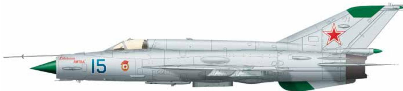
Самый массовый в мире сверхзвуковой самолет, истребитель с треугольным крылом. Находился в производстве четверть века, поступил на вооружение 49 государств, во многих из которых используется и в наши дни. Создан для замены МиГ-19, в полтора раза превосходит его по скорости. Успех самолету обеспечили высокие летные данные при сравнительно невысокой стоимости в производстве и неприхотливости в эксплуатации. МиГ-21 имел более десяти серийных модификаций.
