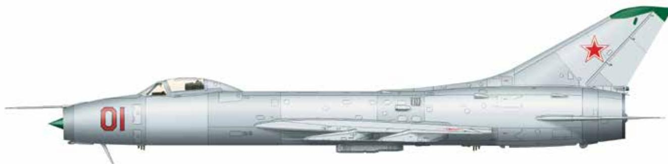
Всепогодный сверхзвуковой истребитель-перехватчик с треугольным крылом, бортовым радиолокатором и ракетным вооружением. В момент появления был самым скоростным серийным самолетом в СССР, имел наибольшую максимальную высоту полета. Однако летчики жаловались на недостаточно надежную работу двигателя и большую посадочную скорость. Кроме того, насыщенный радиоэлектроникой Су-9 оказался дорогим и сложным в производстве самолетом.
