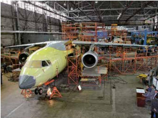
Рис. 7.2. Сборка самолета Ан-148 в Воронеже
