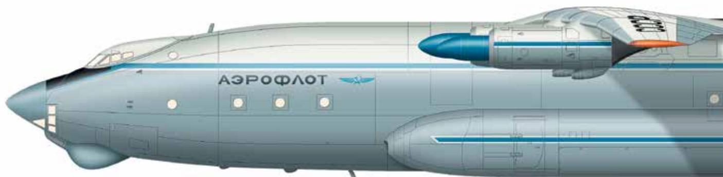
Военно-транспортный турбовинтовой самолет, в свое время — самый большой в мире. Кроме размеров, Ан-22 отличался необычными 12-колесными тележками основных опор шасси с независимой рычажной подвеской колес, двухкилевым вертикальным оперением, применением новых конструкционных материалов. В герметизированном фюзеляже за пилотской кабиной расположен отсек на 29 мест, за ним — грузовой отсек длиной 32,7 м и шириной 4,4 м. Его усиленный пол выдерживал вес многотонных гусеничных и колесных машин.
