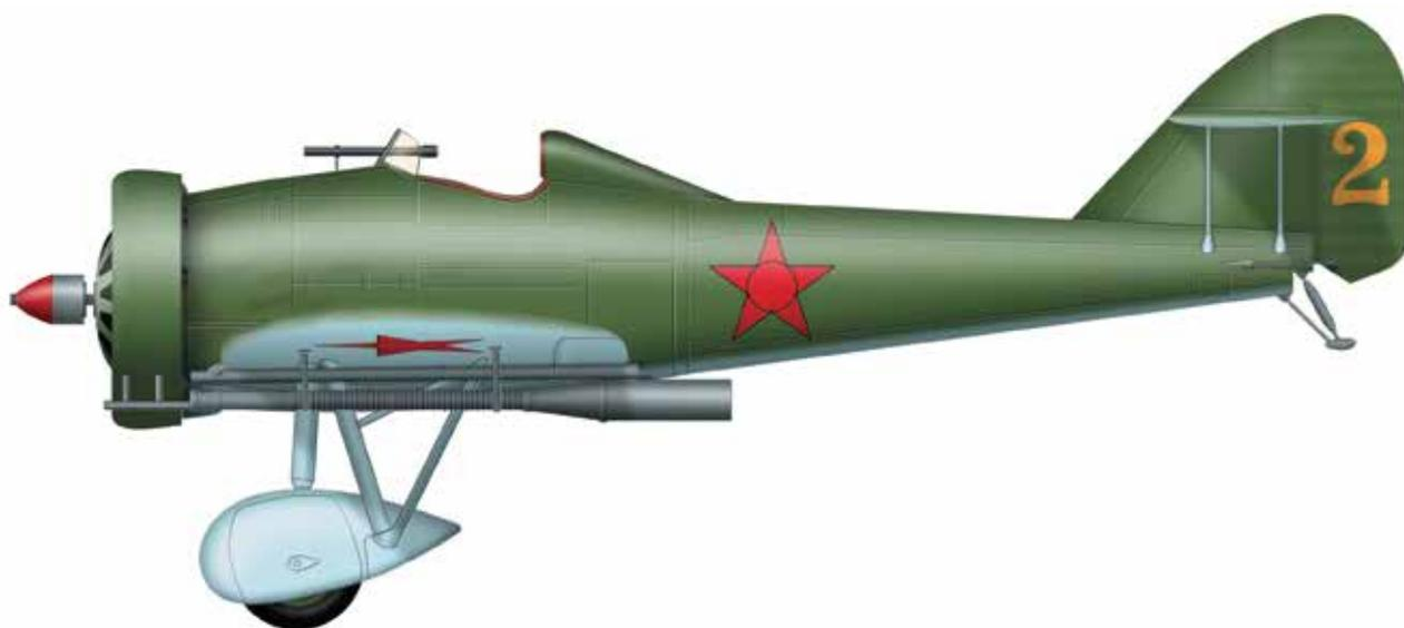
Этот истребитель был спроектирован Д.П. Григоровичем специально под крупнокалиберные динамо-реактивные пушки конструкции Л.В. Курчевского. Самолет металлический, обшивка крыла частично полотняная. Крыло с подкосами, шасси неубирающееся, двигатель воздушного охлаждения. Пушки устанавливались под крылом, вне диска вращения винта. Из-за их низкой скорострельности боевая эффективность самолета оказалась низкой.
