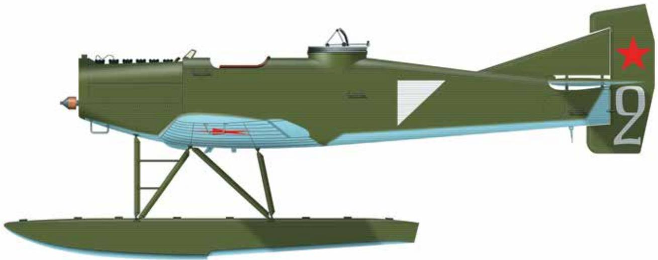
Поплавковый двухместный разведчик цельнометаллической конструкции, первый в СССР серийный дюралюминиевый гидросамолет. Обшивка гофрированная. Развитие почтового гидросамолета Юнкерс А.20W, появившегося в 1922 г. Строился на концессионном предприятии фирмы «Юнкерс» в Филях в 1923-1924 гг. Применялся в авиации Балтийского и Черноморского флотов до 1930 г., позднее несколько экземпляров использовали для полетов на Севере.
