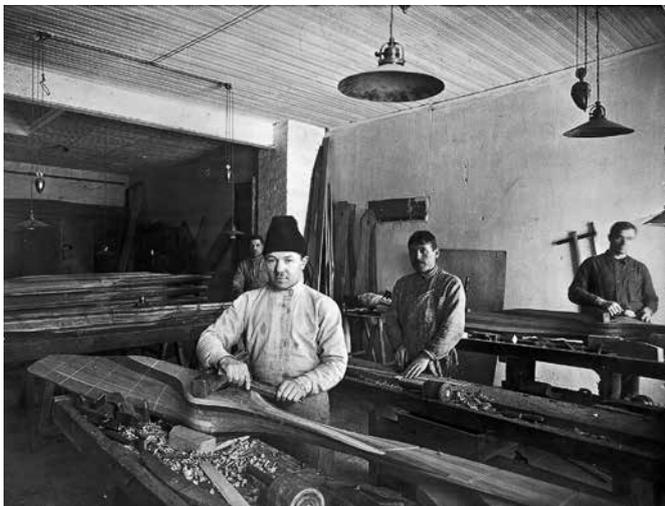
Рис. 1.3. Производство пропеллеров на ПРТВ
