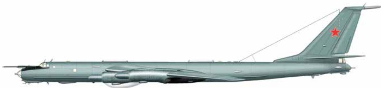
Дальний противолодочный самолет. Разработан в середине 60-х годов на основе бомбардировщика Ту-95. На самолете установлено новое крыло, доработана система управления, изменен состав оборудования и вооружения. Вариант Ту-142М с усовершенствованной поисково-прицельной системой стоит на вооружение авиации ВМФ России.
