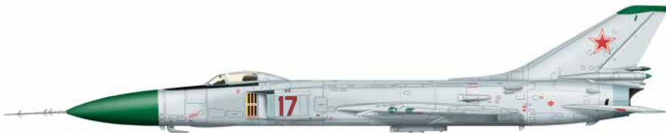
Истребитель-перехватчик. В отличие предыдущих перехватчиков ОКБ П.О. Сухого Су-9 и Су-11 имел два турбореактивных двигателя, боковые воздухозаборники, усовершенствованную РАС, полностью автоматическую систему перехвата целей. В 1970 г. в серию была запущена модификация Су-15ТМ с новой РАС и более мощными двигателями.
