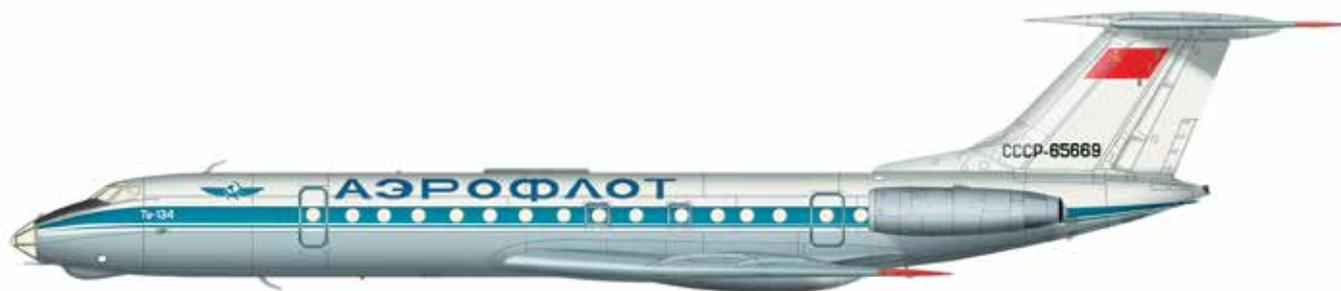
Среднемагистральный пассажирский самолет, первый отечественный авиалайнер с двигателями в хвостовой части фюзеляжа. Крыло как на Ту-124, длина фюзеляжа увеличена. Кроме 72-местного Ту-134, выпускали 76-местный Ту-134А и 80-местный Ту-154Б, Ту-134УБЛ с измененной носовой частью для подготовки летчиков дальней авиации, Ту-134СХ для сельскохозяйственных работ. Созданный в середине 60-х, Ту-134 до сих пор находится в эксплуатации.
