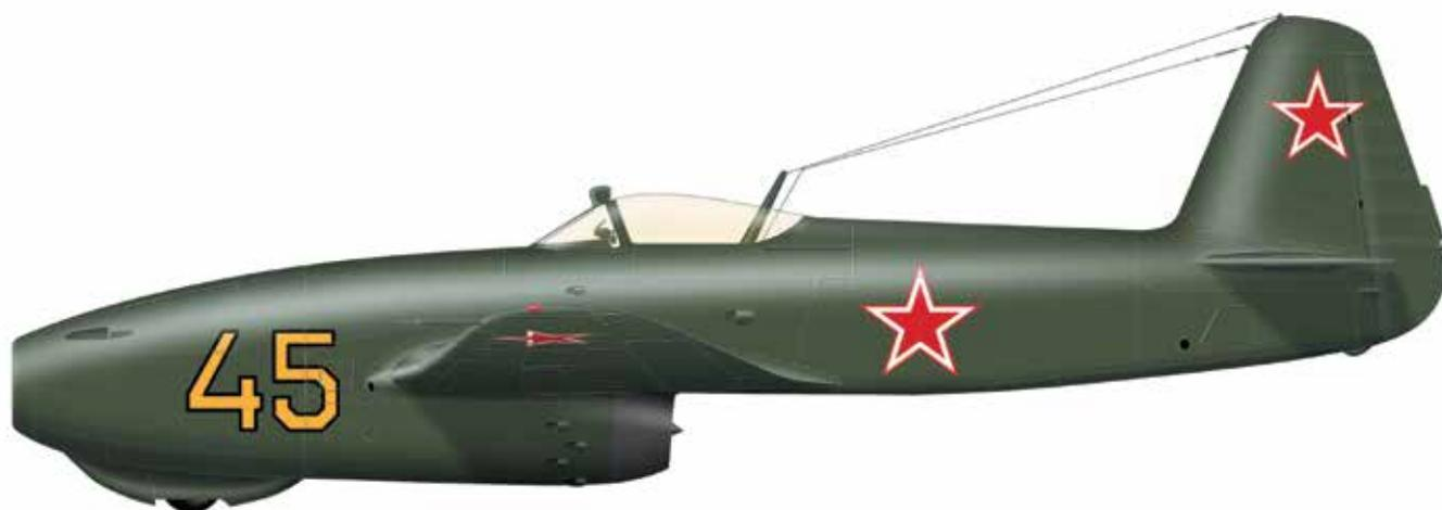
Развитие истребителя Як-15. Як-17 отличался трехколесным шасси с передней опорой и дополнительными топливными баками в концевых частях крыла. Двухместный Як-17УТИ был первым в стране учебно-тренировочным реактивным истребителем.
