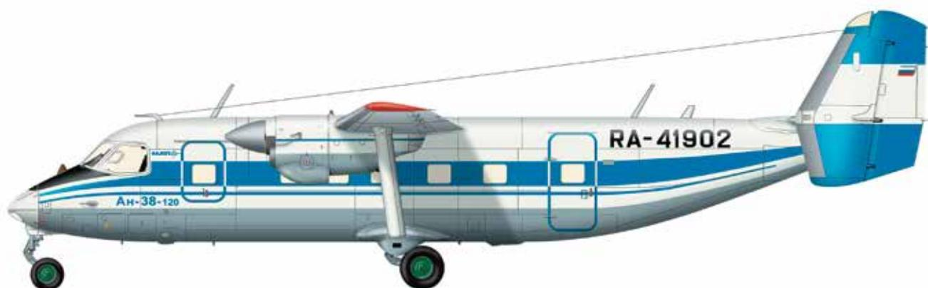
Турбовинтовой транспортно-пассажирский самолет для местных воздушных линий. Разработан АНТК им. О.К. Антонова. В России производство Ан-38 велось на заводе «Сокол» в Нижнем Новгороде. В апреле 2000 г. получен сертификат типа. Единственный в мире самолет, эксплуатация которого разрешена до температуры  $-50^{\circ}\text{C}$ .
