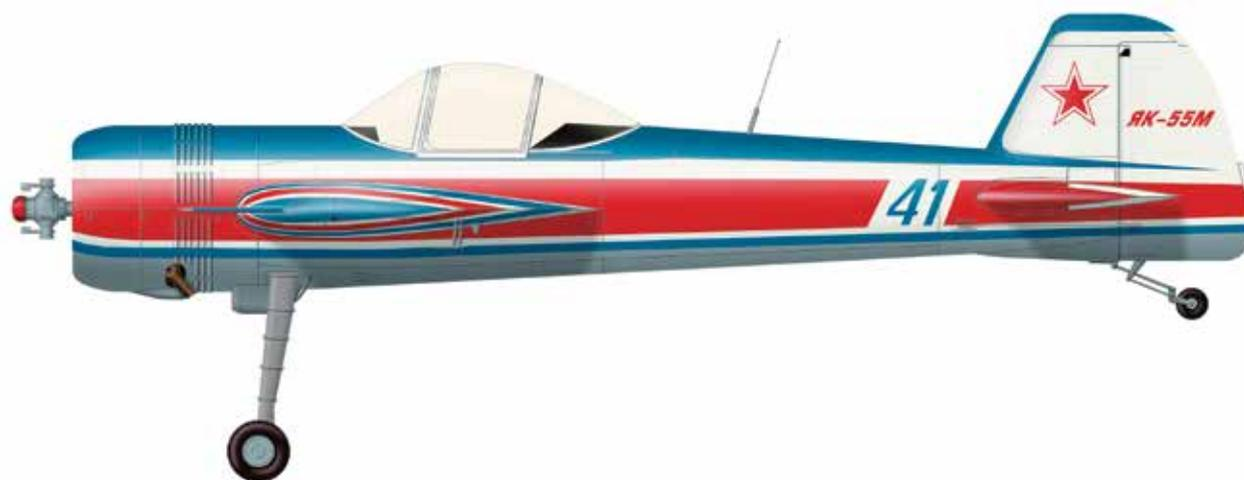
Одноместный спортивно-пилотажный самолет, преемник Як-50. Конструкция цельнометаллическая, шасси неубирающееся, рессорное, с хвостовой опорой. Среднее расположение крыла с симметричным профилем, хорошая управляемость и высокая энерговооруженность позволяют выполнять комплексы фигур высшего пилотажа без потери высоты. В варианте Як-55М крыло уменьшено по площади и по размаху, в результате максимальная скорость вращения вокруг продольной оси увеличилась в полтора раза.
