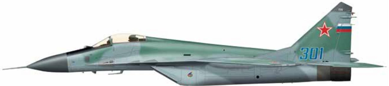
Истребитель нового поколения, самолет с плавным сочленением крыла и фюзеляжа, подкрыльевыми воздухозаборниками и большим корневым наплывом крыла, генерирующим подъемную силу на больших углах атаки. Автоматически отклоняемые предкрылки и закрылки формируют оптимальную кривизну профиля крыла в зависимости от режима полета. Самолет отличается превосходной маневренностью.
