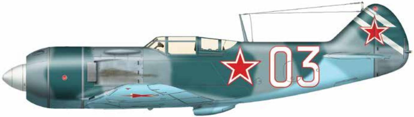
Развитие самолета Ла-5. Благодаря замене деревянных лонжеронов крыла металлическими удалось увеличить объем крыльевых топливных баков, снизить вес конструкции. Аэродинамические усовершенствования, в частности, тщательная внутренняя герметизация планера самолета, обеспечили прирост максимальной скорости более чем на 20 км/ч.
