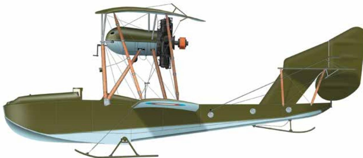
Летающая лодка-истребитель. Спроектирована Д.П. Григоровичем на заводе ПРТВ. По конструкции в целом аналогична самолетам М-5 и М-9. Вооружена направленным вперед пулеметом, имела бронезащиту экипажа. Вариант М-12 — с двухместной кабиной, броня не устанавливалась. Несмотря на изначальное назначение, самолет применялся в основном как разведчик.
