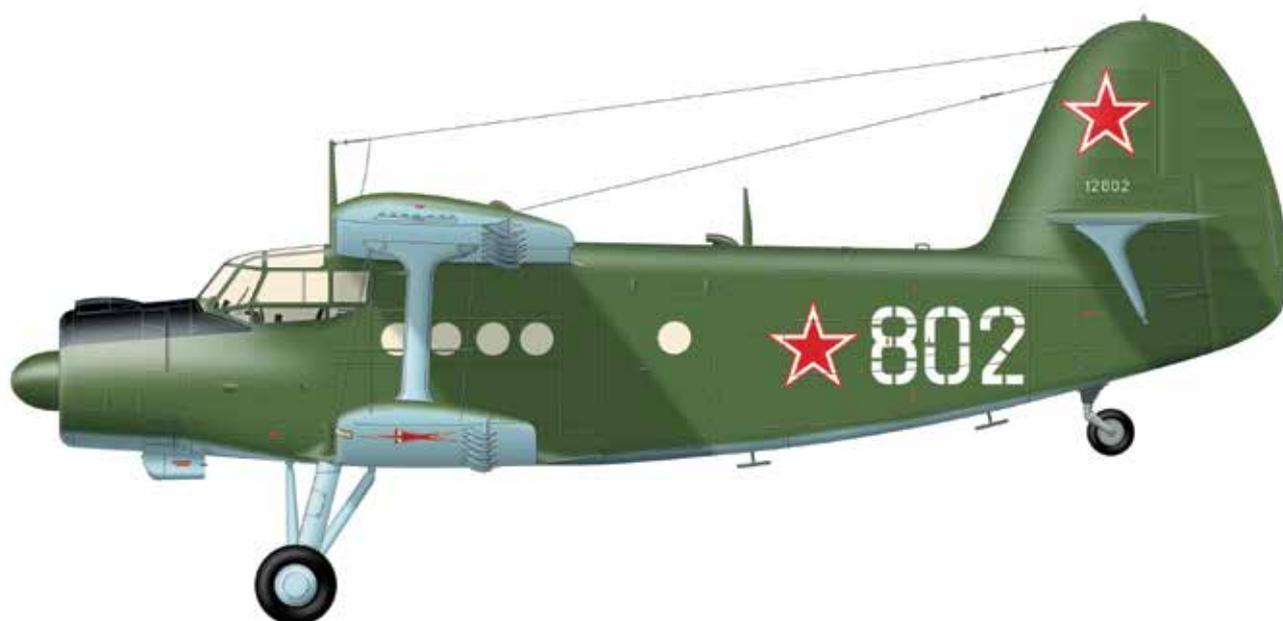
Первый самолет ОКБ О.К. Антонова. Имел необычную для послевоенных лет схему биплан. Благодаря двум крыльям, оборудованным посадочной механизацией, отличался большой грузоподъемностью и превосходными взлетно-посадочными характеристиками, мог действовать практически с любых аэродромов. Конструкция самолета металлическая, крылья и оперение — с полотняной обшивкой. Применялся для различных задач — перевозки пассажиров, грузовых перевозок, сельскохозяйственных работ, как
