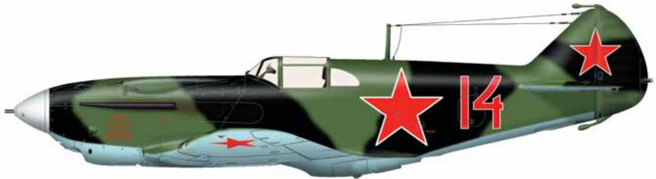
Самолет С.А. Лавочкина, В.П. Горбунова и М.И. Гудкова, одна из трех новых моделей истребителей, появившихся в ВВС накануне Великой Отечественной войны. Конструкция деревянная, с применением в полках лонжеронов и других ответственных элементах композиционного материала «дельта-древесина», значительно превосходящего по прочности обычную сосну. Самолет обладал хорошей обтекаемостью, но был несколько перетяжелен.
