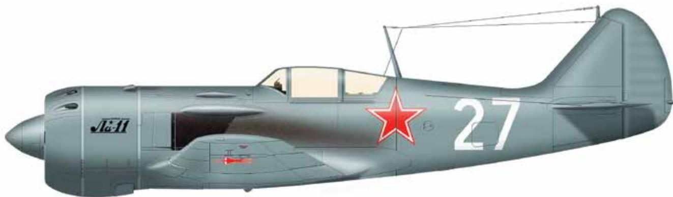
Последний советский истребитель с поршневым двигателем. Создан на основе Ла-9 для сопровождения и охраны бомбардировщиков. Для большего радиуса действия емкость топливных баков значительно увеличили, было предусмотрено применение дополнительных баков на концах крыла. В результате дальность выросла почти в полтора раза. Ла-11 принимали участие в боевых действиях в Корее.
