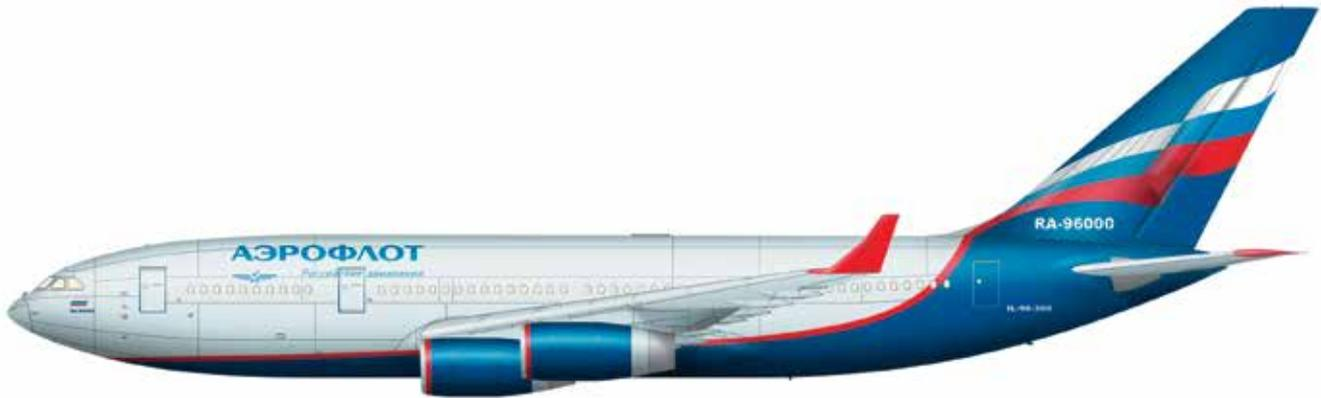
Дальнемагистральный широкофюзеляжный пассажирский самолет. Для достижения заданной дальности полета на Ил-96 установлено крыло большого удлинения с суперкритическим профилем и двигатели с высокой степенью двухконтурности. Впервые в СССР на пассажирской машине применена электродистанционная система управления. Сертификат типа получен 29.12.1990 г. Запуск Ил-96 в серийное производство пришелся на время, когда в стране разразился экономический
