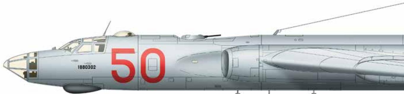
Дальний реактивный бомбардировщик. Создан на замену поршневому Ту-4. Первый серийный самолет Туполева со стреловидным крылом. Имел оригинальную компоновку с размещением двигателей в основании крыла. Выпускался более 10 лет, а на вооружении ВВС и ВМФ пробыл до начала 90-х годов. Как всякий самолет-долгожитель имел много модификаций. Сначала самолет строили в варианте бомбардировщика, затем — ракетноносца. Последним из семейства был Ту-16К-10 — носитель сверхзвуковой крылатой ракеты К-10С.
