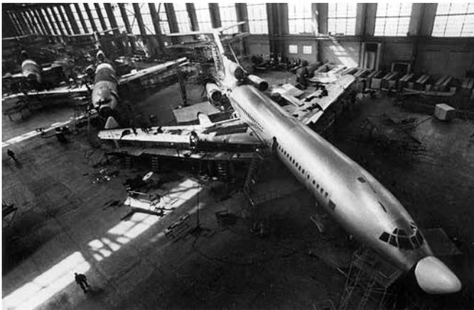
Рис. 6.6. Сборка Ту-154 на Куйбышевском авиазаводе. 1972
