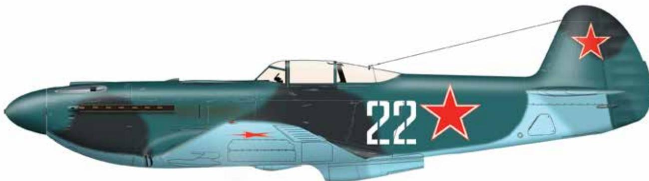
Самая массовая модель истребителя времен Великой Отечественной войне. Отличалась от Як-7Б более совершенной конструкцией за счет замены деревянных лонжеронов крыла дюралевыми, улучшенной аэродинамикой и повышенной эксплуатационной надежностью. Во время войны выпускали восемь модификаций Як-9 с двигателями М-105ПФ и ВК-107А, с различным вооружением и дальностью полета. После войны строили Як-9П с металлической конструкцией планера самолета.
