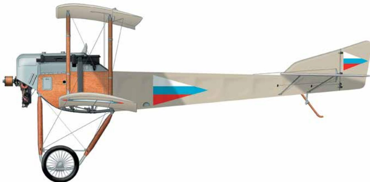
Первый российский истребитель. Сконструирован И.И. Сикорским в конце 1914 г., применялся в фронтовой авиации в качестве истребителя, затем из-за невысоких скоростных данных использовался только в ЭВК. Конструкция деревянная, обшивка полотняная, вооружение — синхронный пулемет, приспособленный для стрельбы через винт. На С-16 воевали русские летчики-асы И.А. Орлов, Ю.В. Гильшер, К.К. Вакуловский, М.Г. Лерхе.
