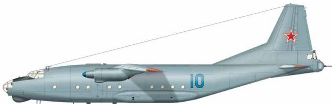
Первый в СССР специализированный военно-транспортный самолет. Имел характерную для всех последующих грузовых самолетов схему с высокорасположенным крылом, низким убирающимся в фюзеляж шасси и большим грузовым люком в хвостовой части фюзеляжа. Двигатели — турбовинтовые. Мог эксплуатироваться как с бетонированных, так и с грунтовых аэродромов. Строился сравнительно небольшой серией, т. к. одновременно началось производство более грузоподъемного Ан-12.
