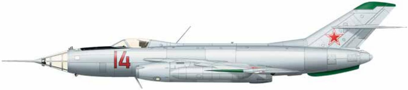
Одноместный сверхзвуковой истребитель-перехватчик, созданный на основе самолета Як-25. Имел более мощные двигатели, обтекатель радиолокатора заостренной формы, крыло тонкого профиля. В дополнении к пушке самолет вооружили неуправляемыми ракетами на выдвижных установках. Як-27 выпустили малой серией, основной производственной моделью стал двухместный Як-27Р — первый в СССР сверхзвуковой фоторазведчик.
