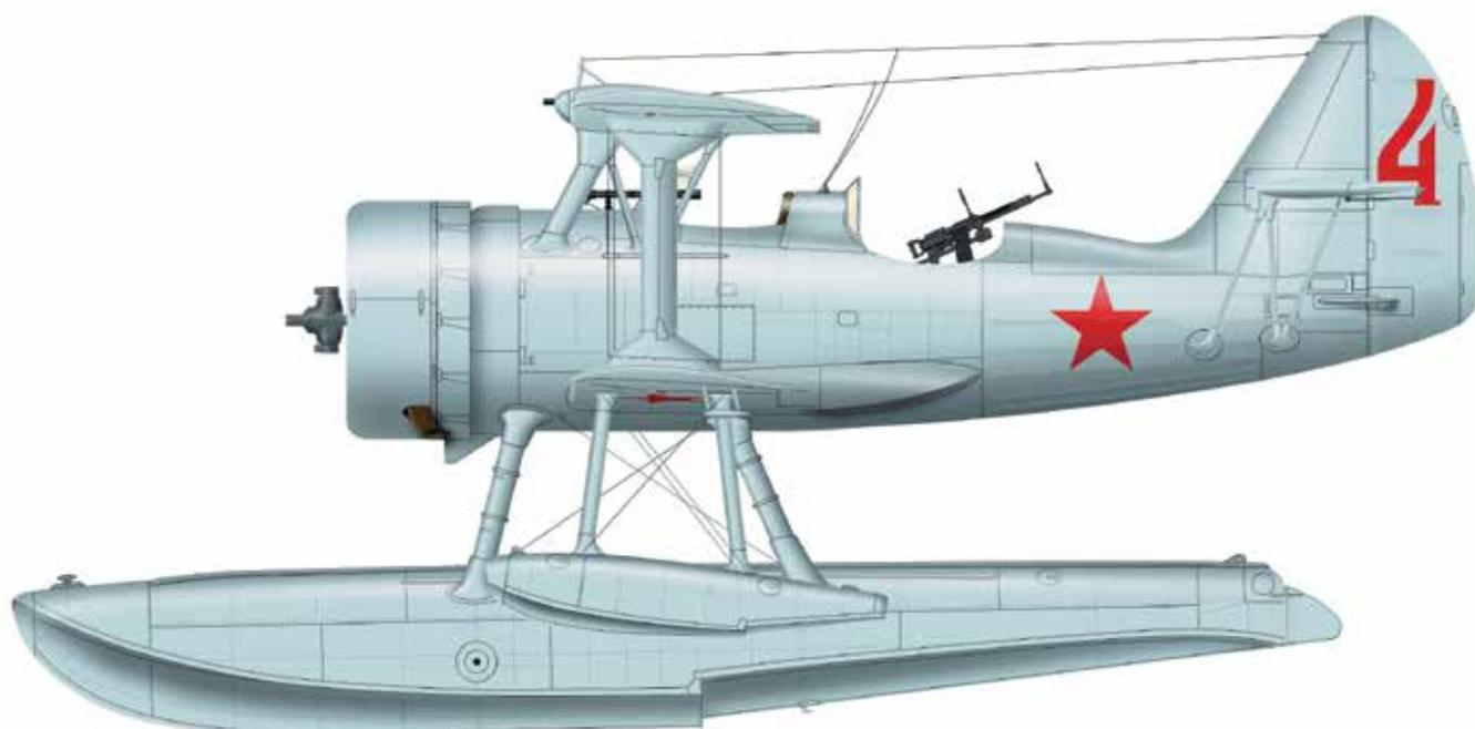
Корабельный разведчик, предназначенный для старта с установленной на корабле катапульты. Сконструирован в ОКБ Г.М. Бериева для замены аналогичного самолета КР-1, строившегося для СССР в Германии. Представлял собой двухместный одноплывковый биплан смешанной конструкции. С началом войны шасси КОР-1 переделали на колесное и использовали самолеты как штурмовики.
