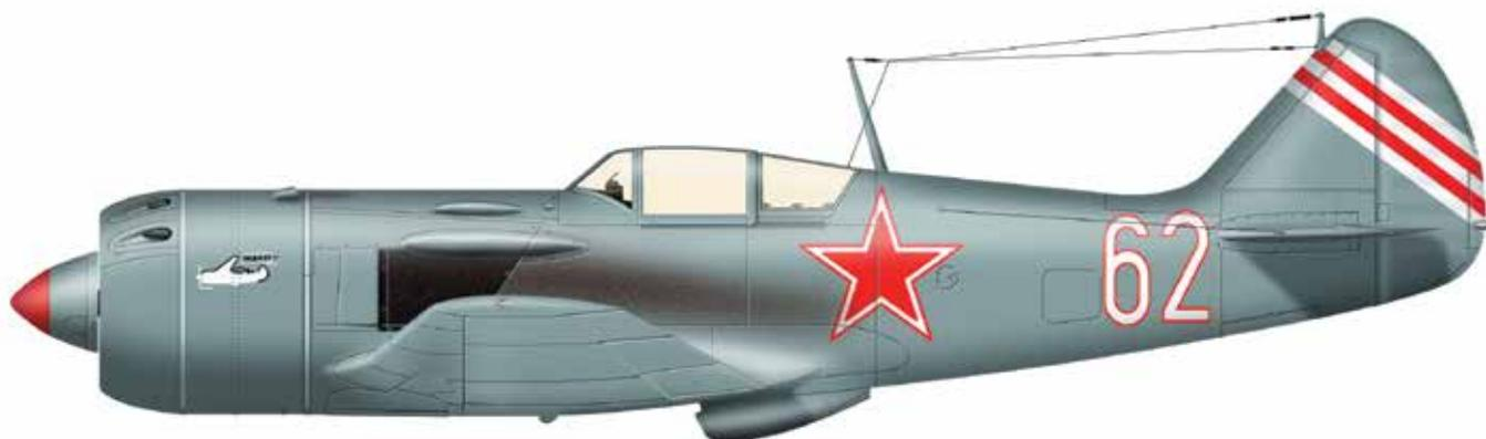
Первый послевоенный истребитель. В отличие от Ла-7 имел цельнометаллическую конструкцию для обеспечения долговечности самолета (в условиях мирного времени это вновь стало очень важно). Кроме того, Ла-9 обладал усовершенствованным профилем крыла, увеличенной емкостью баков, более мощным вооружением и более разнообразным приборным оборудованием. Двухместный учебно-тренировочный вариант самолета назывался Ла-9УТИ или Ла-9В («вывозной»).
