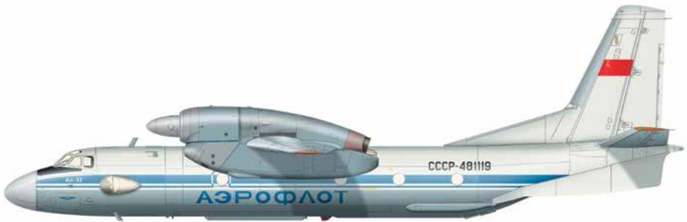
Многоцелевой транспортный самолет, развитие Ан-26. Создан для экспорта в страны с жарким климатом, при этом предусмотрена возможность полетов с высокогорных аэродромов. На нем установлены значительно более мощные, чем на Ан-26, двигатели и новая вспомогательная силовая установка для автономной эксплуатации самолета. Ан-32 используются в Индии, странах СНГ, Ливии, ОАЭ, Судане, Шри-Ланке.
