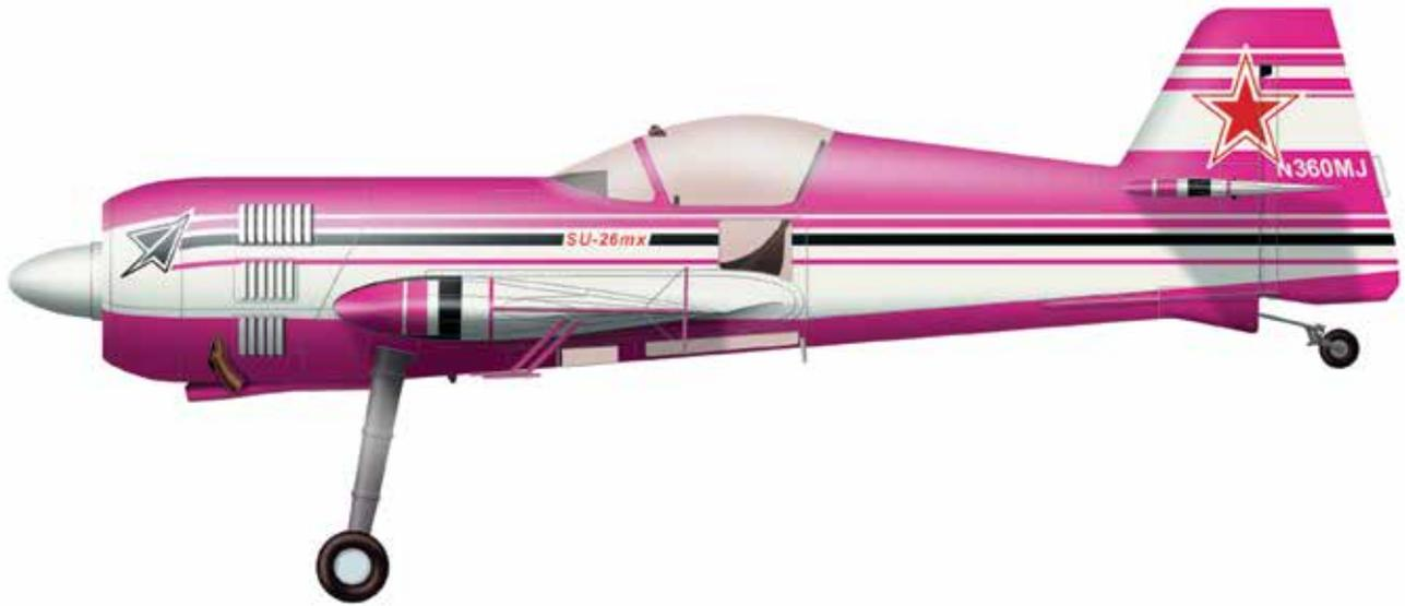
Одноместный спортивный самолет, первый самолет такого типа ОКБ П.О. Сухого. Его особенностями являются крыло симметричного профиля для лучшей маневренности и очень легкая конструкция с использованием композиционных материалов, причем на модели Су-26М их доля значительно возросла. Су-26МХ предназначен для экспорта и отличается увеличенной емкостью топливных баков.
