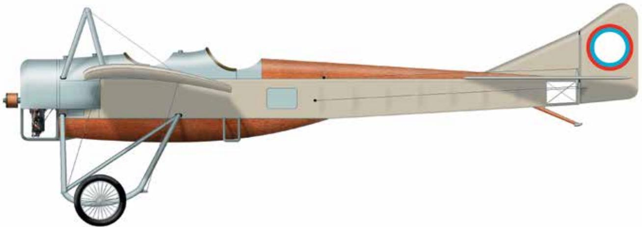
Разведчик и связной самолет. Французский двухместный моноплан конструкции Л. Бешеро, создан в 1912 г. на основе гоночных самолетов фирмы «Депердюссен». Имел деревянную конструкцию с полотняной обшивкой. В России участвовал в конкурсе военных самолетов 1913 г., где занял третье место, после чего строился в серии. Применялся на фронте до середины 1916 г., использовался также в авиашколах.
