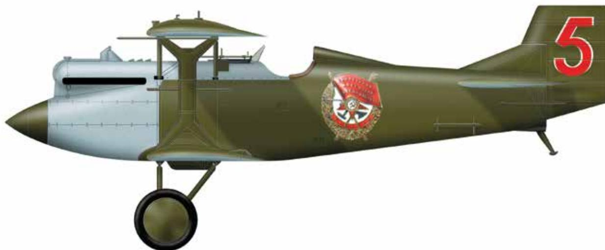
Первый сконструированный в СССР истребитель, который бы принят на вооружение. Создан Д.П. Григоровичем в 1924 г. Одностоечный деревянный биплан. Модификация И-2 бис отличалась более просторной кабиной пилота и усиленной конструкцией фюзеляжа (в ее среднюю часть добавили ферму из стальных труб). Кроме вновь построенных машин, переделки в И-2 бис подверглась часть изготовленных ранее И-2. Из-за невысокой скорости самолет построили небольшой серией.
