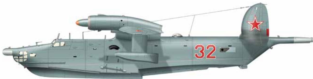
Турбовинтовая летающая лодка-амфибия, дальний морской разведчик и противолодочный самолет. Значительно превосходил Бе-10 по продолжительности полета и больше подходил для поиска и уничтожения подводных лодок. Кроме того, Бе-12 обладал лучшими мореходными качествами, мог взлетать и садиться при значительном волнении на море. Кроме противолодочных Бе-12 строили также поисково-спасательные Бе-12ПС.
