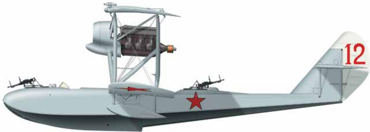
Лицензионное воспроизводство итальянской летающей лодки С-62 бис — четырехместного деревянного биплана 1926 г. выпуска. На самолетах устанавливали итальянские двигатели Ассо 750R. Попытка приспособить МБР-4 под отечественный мотор М-34 не удалась, что послужило причиной снятия самолета с производства. Его заменил советский МБР-2.
