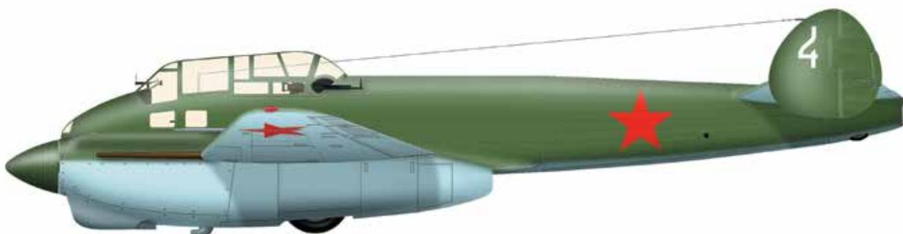
Первый боевой самолет ОКБ А.С. Яковлева, скоростной двухмоторный моноплан. Конструкция смешанная: крыло деревянное, фюзеляж – металлический, частично с полотняной обшивкой. Опытный образец с моторами М-103 развил скорость 567 км — больше, чем у истребителей. Самолет создавался как разведчик, но затем был переделан в ближний бомбардировщик (Як-2). После установки пулеметов и бомб летные характеристики заметно снизились. Они были восстановлены на Як-4 с моторами М-105 (Як-4).
