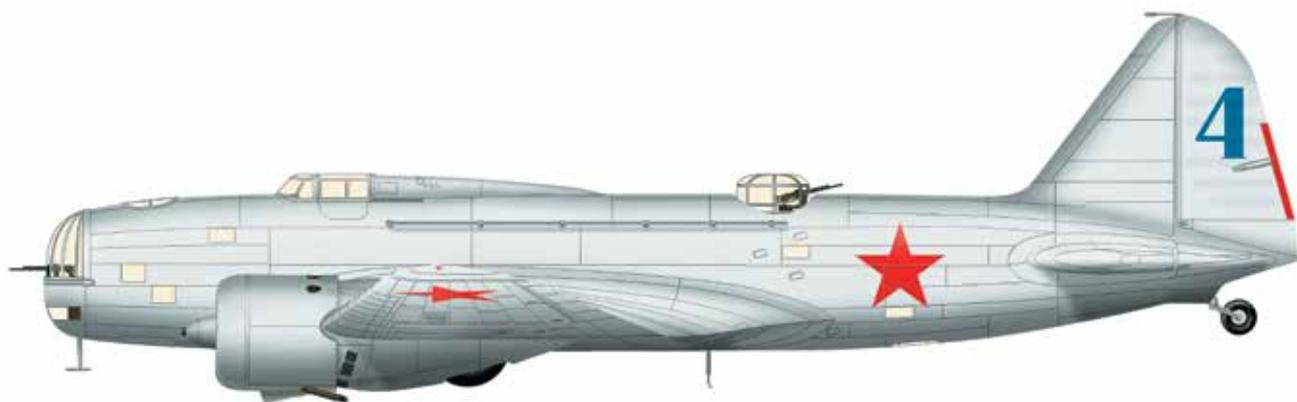
Дальний бомбардировщик, первый серийный самолет С.В. Ильюшина. Благодаря гладкой обшивке и убирающемуся в полете шасси этот двухмоторный цельнометаллический моноплан почти вдвое превосходил по скорости бомбардировщики ТБ-1 и ДБ-1. На самолетах устанавливали моторы воздушного охлаждения М-85, М-86, М-87 и М-88. Кроме бомбардировщиков выпускали также торпедоносец ДБ-3Т.
