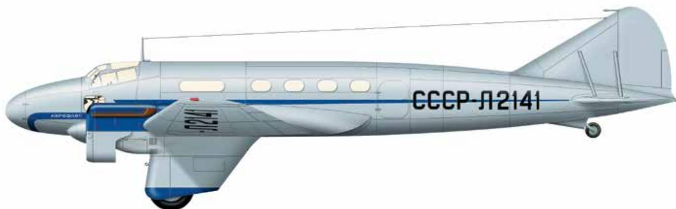
На московском ремонтном заводе ГВФ № 89 по проекту французского инженера А. Лявиля, работавшего по контракту в СССР, сконструировали двухмоторный цельнометаллический пассажирский скоростной моноплан. Было изготовлено семь самолетов, получивших обозначение ПС-89. Они летали в «Аэрофлоте» до начала войны.
