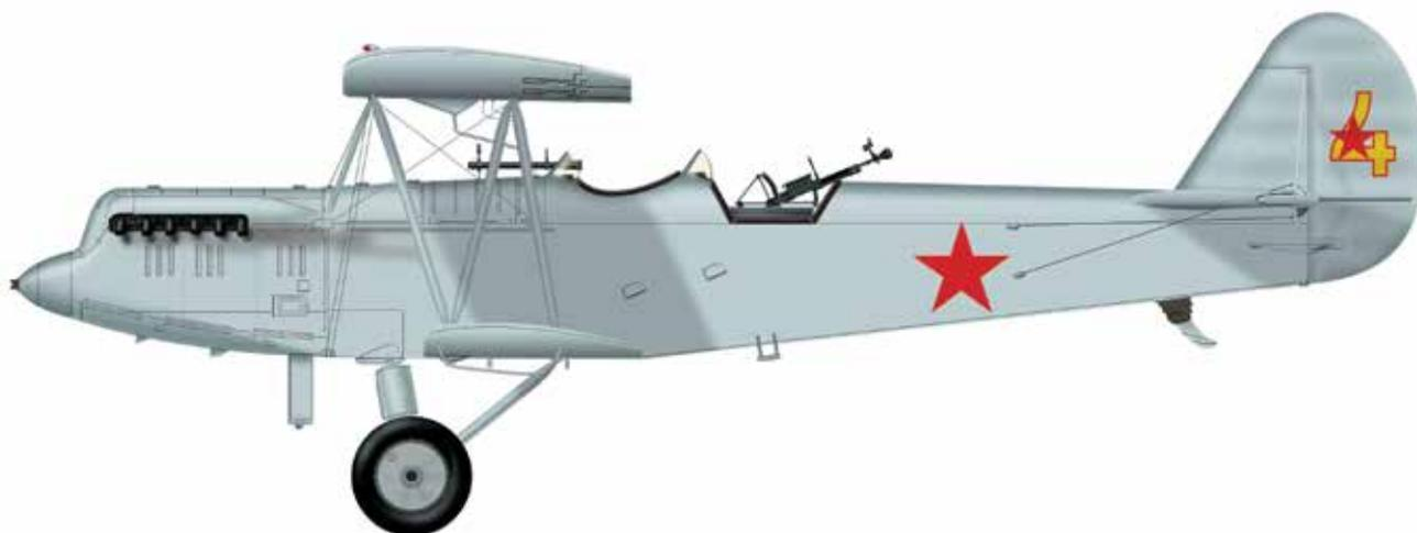
Самый массовый советский разведчик и легкий бомбардировщик довоенного периода. Конструктор Н.Н. Поликарпов. Самолет имел деревянную конструкцию, крылья обтянуты полотном, кабина — двухместная, двигатель — водяного охлаждения, с выдвижным радиатором. Выпускался на протяжении 7 лет, участвовал в боевых действиях в Китае, в Испании, в начальный период Великой Отечественной войны. Р-5 был первым советским самолетом, продававшимся за рубеж: в 1931 г. Иран купил 10 этих разведчиков.
