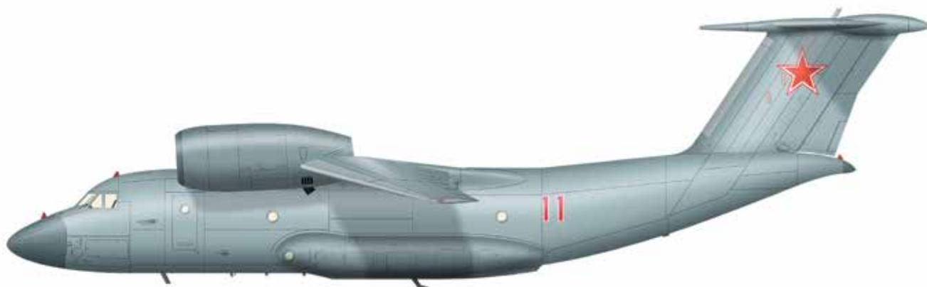
Многоцелевой транспортный самолет укороченного взлета и посадки. Создавался для замены Ан-26. Основной его особенностью является компоновка двигателей, при которой струя газов обдувает верхнюю часть крыла. Это было сделано, чтобы повысить коэффициент максимальной подъемной силы за счет эффекта «прилипания» струи к поверхности крыла и посадочной механизации. Гражданский вариант самолета называется Ан-74.
