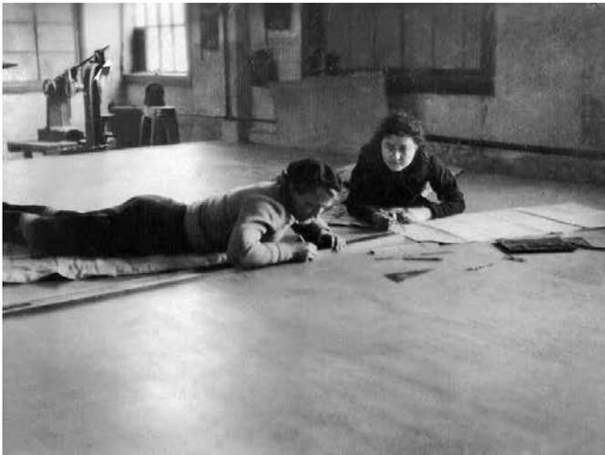
Рис. 4.9. Изготовление плазов бомбардировщика Ер-2
