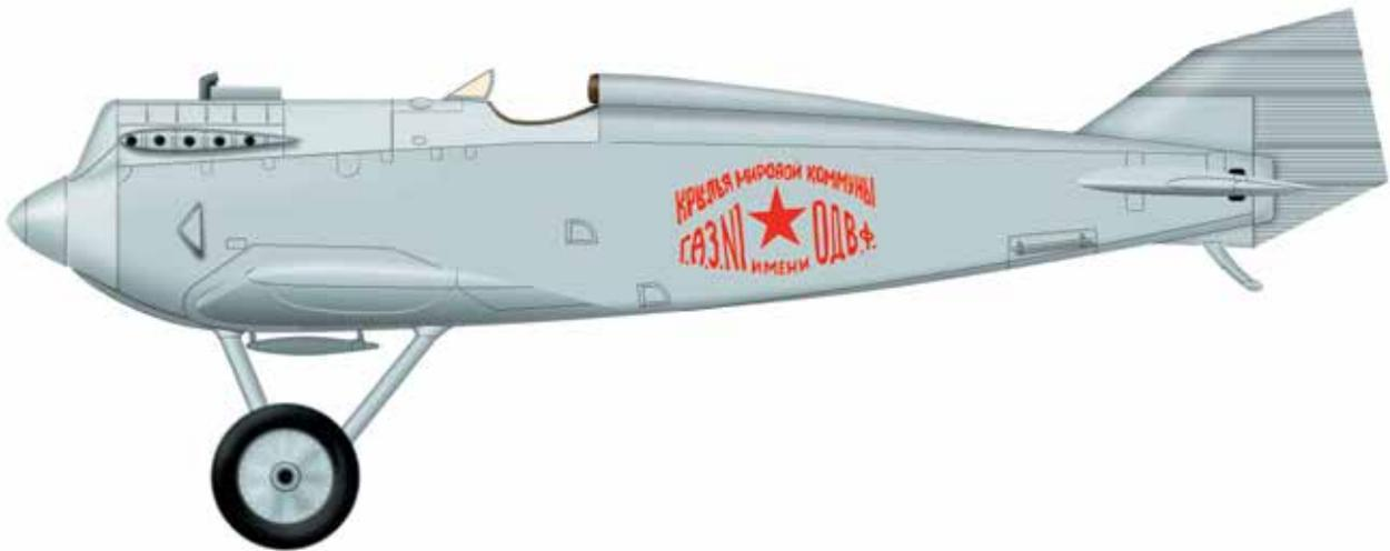
Первый в стране истребитель схемы «свободнонесущий моноплан», первый самолет Н.Н. Поликарпова. Испытания опытного образца начались в 1923 г., в 1926-1927 гг. на заводе № 1 в Москве была изготовлена серия 14 экземпляров. Конструкция самолета деревянная, с фанерной обшивкой. И-1 отличался высокой для своего времени скоростью полета, но из-за плохих штопорных характеристик его не приняли на вооружение.
