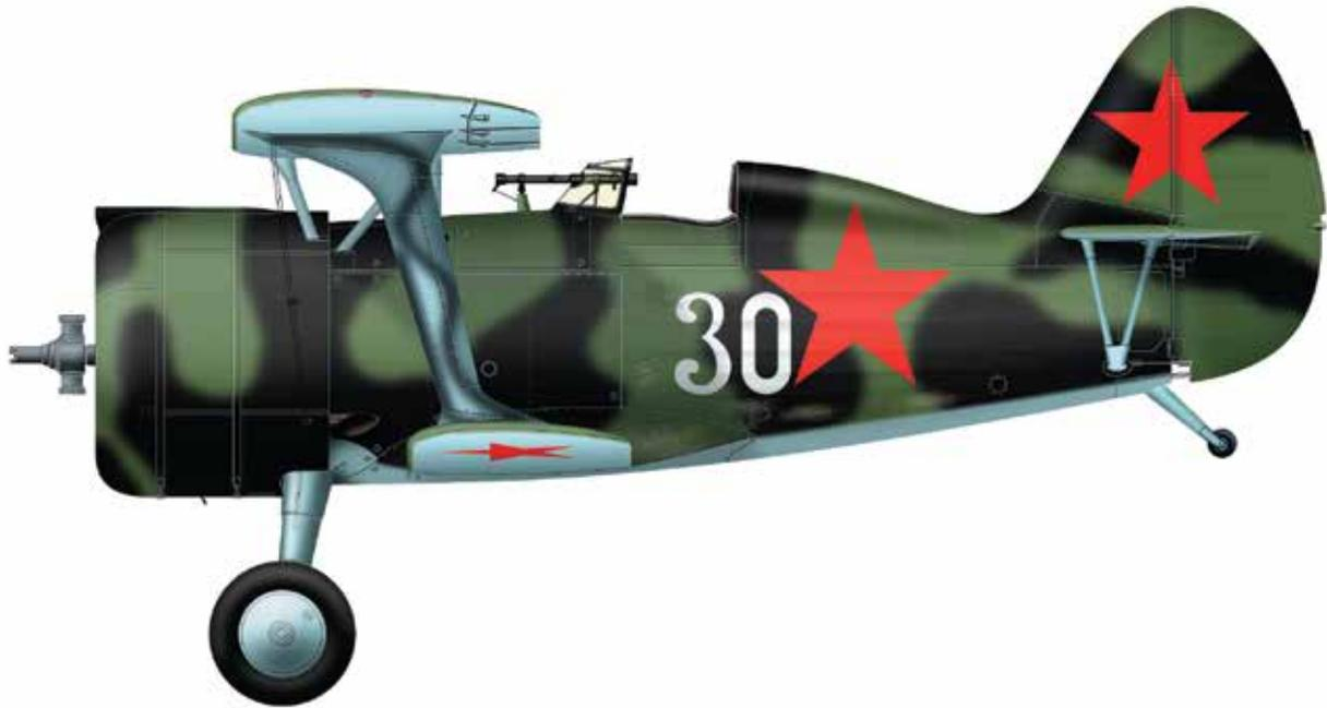
Истребитель Н.Н. Поликарпова, одноместный биплан смешанной конструкции с двигателем воздушного охлаждения, развитие самолета И-5. Отличался высокой маневренностью. Большинство машин было выпущено в модификации И-15 бис со спрямленной центральной частью верхнего крыла. На самолетах устанавливали двигатели М-22 и М-25.
