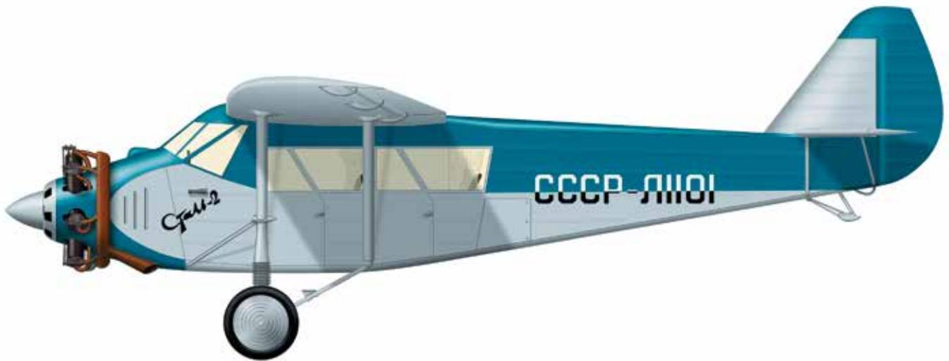
«Сталь-2» — первый в мире самолет с каркасом из нержавеющей стали. Его сконструировал сотрудник ЦАГИ А.И. Путилов. Детали самолета делали из гнутых листов нержавеющей стали, соединяемых электросваркой, снаружи корпус обшивался фанерой и полотном. Эти пассажирские монопланы с мотором воздушного охлаждения летали на линиях «Аэрофлота».
