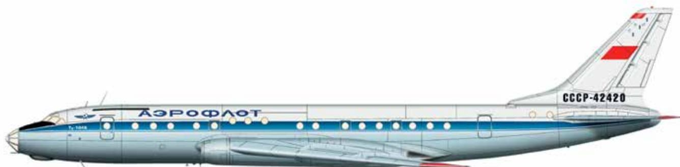
Первый в СССР турбореактивный пассажирский самолет. Создан на основе бомбардировщика Ту-16 с полной заменой фюзеляжа. Вышел на линии «Аэрофлота» в 1956 г. Значительно превосходил по скорости появившейся тогда же турбовинтовой Ил-18, но уступал ему в экономичности перевозок. Первые «Ту» брали на борт 50 пассажиров, затем в результате перекомпоновки салона появился 70-местный Ту-104А, за ним последовал 100-местный Ту-104Б с удлиненным
