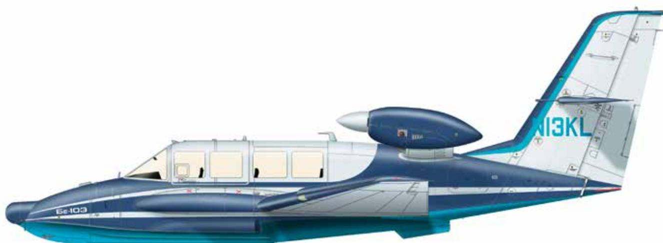
Многоцелевой самолет-амфибия с двумя поршневыми двигателями. Предназначен для использования на линиях малой протяженности в различных районах мира, особенно в прибрежных и островных государствах и в регионах с большим количеством рек, озер, мелких водоемов, труднодоступных для других видов транспорта. Разработан на Таганрогском АНТК им. Г.М. Бериева, строится в серии на заводе в Комсомольске-на-Амуре. В декабре 2001 г. получен сертификат типа.
