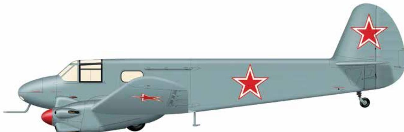
Простой в производстве и пилотировании двухмоторный самолет деревянной конструкции с полотняной обшивкой. Использовался как связной, для переброски грузов весом до 500 кг, перевозки 5-6 пассажиров, полетов к партизанам. Был разработан, но в серии не выпускался вариант Як-6 НББ (ночной ближний бомбардировщик) с 500 кг бомб.
