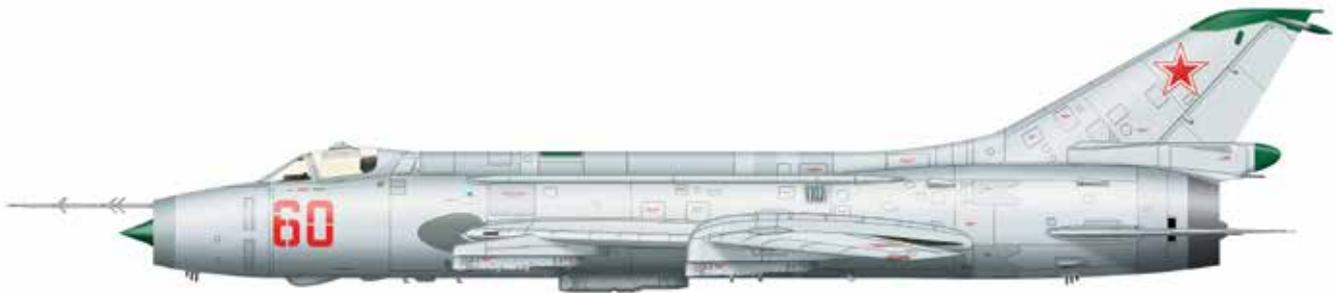
Истребитель-бомбардировщик с крылом изменяемой стреловидности. Создан на базе самолета Су-7Б, поворотное крыло позволило заметно улучшить взлетно-посадочные характеристики. Имел много модификаций, от варианта к варианту совершенствовалось бортовое оборудование, вооружение, начиная с Су-17М устанавливался новый более мощный двигатель. Су-20 и Су-22 представляли собой экспортные варианты Су-17.
