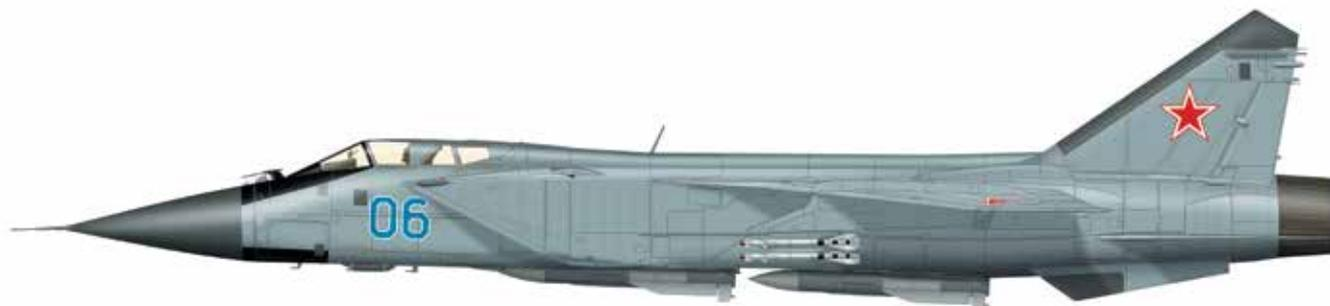
Истребитель-перехватчик, развитие МиГ-25П. Имеет двухместную кабину, двухконтурные форсажные двигатели, значительно более совершенное радиоэлектронное оборудование, усиленное вооружение. По оценке экспертов, группа из четырех МиГ-31 по боевой эффективности эквивалентна полку МиГ-25. Авиазавод в Горьком произвел 503 самолета.\*
