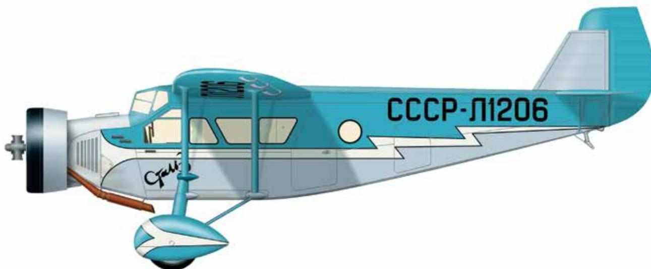
Развитие самолета «Сталь-2». При той же конструкции отличался большими размерами, более мощным двигателем, двухместной кабиной экипажа, некоторыми аэродинамическими усовершенствованиями. Крыло было оборудовано посадочной механизацией.
