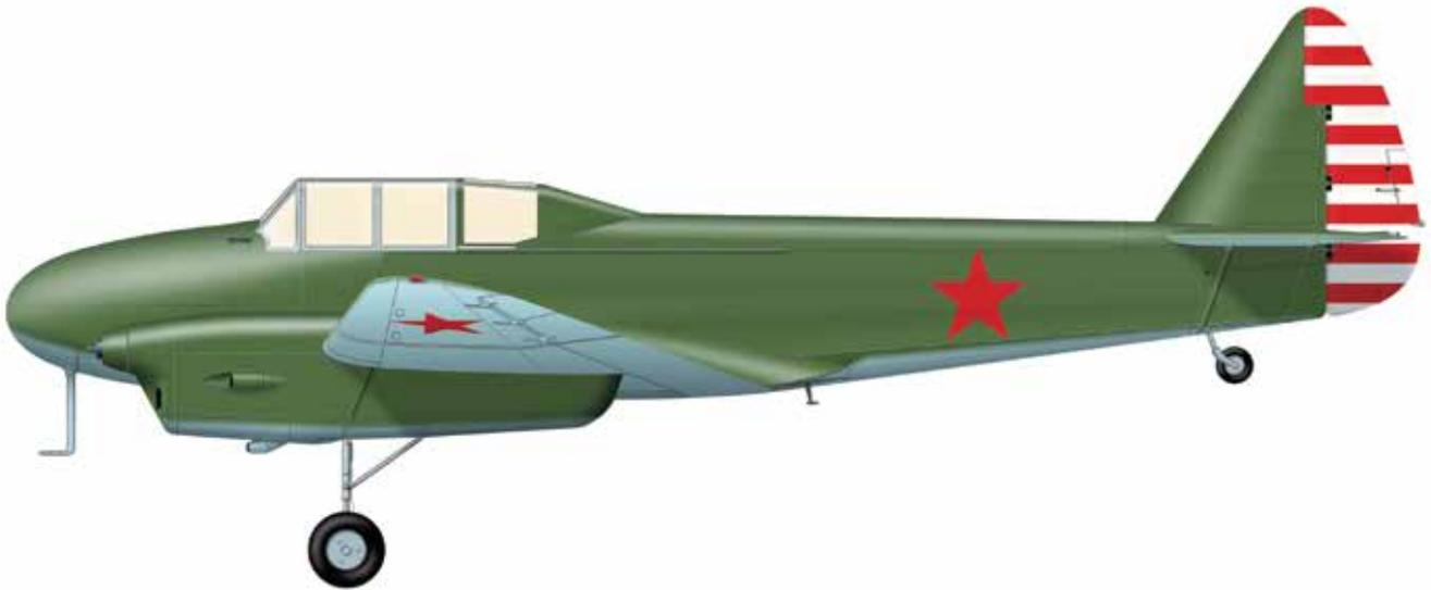
Двухмоторный учебно-тренировочный самолет ОКБ А.С. Яковлева. Предназначен для подготовки летчиков бомбардировочной авиации. Конструкция смешанная: крыло деревянное, фюзеляж — из металлических труб, с полотняной обшивкой. Двигатели фирмы «Рено». Первые экземпляры были трехместными, затем для улучшения летных данных самолет переделали в двухместный и сняли вооружение. Модифицированный УТ-3М в мае 1941 г. выдержал госиспытания и был рекомендован для школ ВВС.
