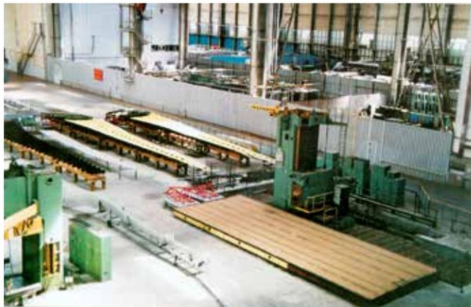
**Рис. 6.13. Станок с ЧПУ для фрезерования длинномерных панелей (Казанское авиапроизводственное объединение)**
