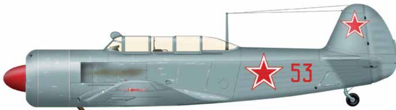
Двухместный учебно-тренировочный истребитель, первый специализированный самолет этого назначения в СССР. Крыло — металлическое, фюзеляж — смешанной конструкции. С 1951 г. выпускался в варианте Як-11У с передней опорой шасси.
