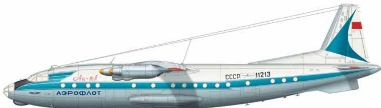
Пассажирский четырехмоторный турбовинтовой самолет ОКБ О.К. Антонова для полетов на авиалиниях средней протяженности. По конструкции в целом идентичен транспортному Ан-12, обе машины проектировались параллельно. Благодаря особенностям шасси мог эксплуатироваться и с бетонированных, и с грунтовых аэродромов. Вариант Ан-10А отличался увеличенным числом пассажирских мест. Самолет пробыл в эксплуатации до 1973 г.
