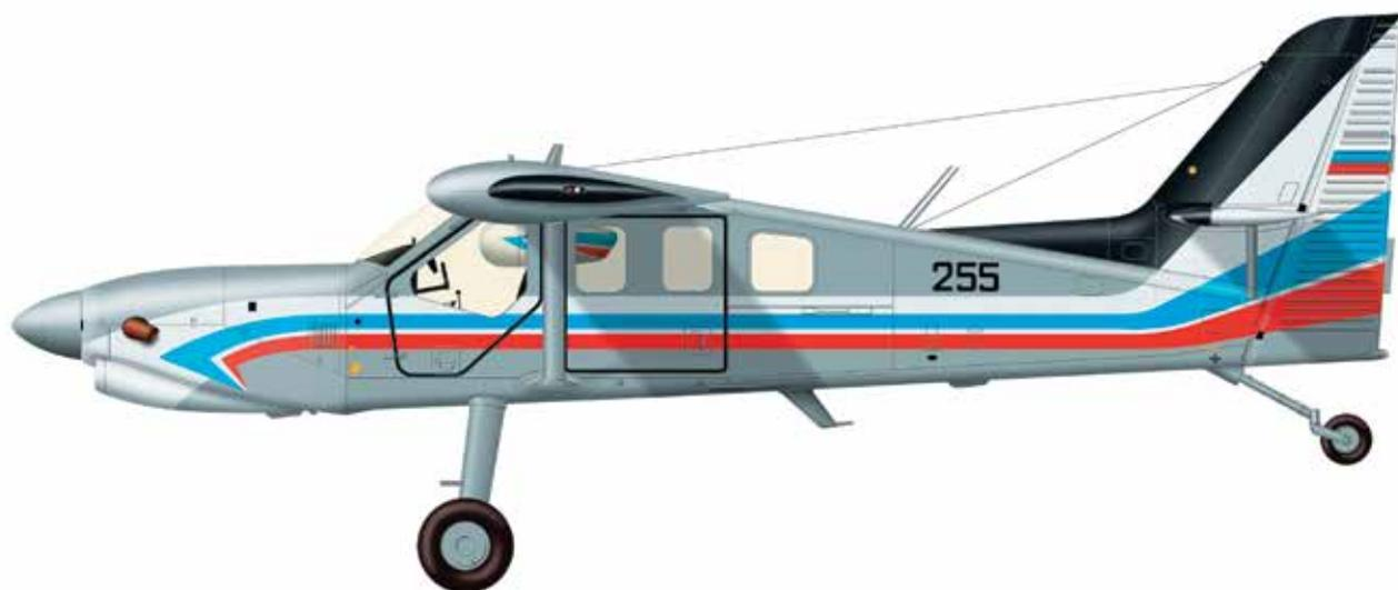
Легкий многоцелевой самолет с двойным управлением, с высокорасположенным подкосным крылом и трехколесным рессорным шасси. Предназначен для патрулирования, перевозки пассажиров и грузов, сельскохозяйственных работ, обучения и тренировки летчиков. Разработан в научно-коммерческой фирме «Техноавиа» (главный конструктор — В.П. Кондратьев), серия — на Смоленском авиазаводе. В декабре 2008 г. получен сертификат типа. Выпускается также в варианте с турбовинтовым двигателем (СМ-92Т).
