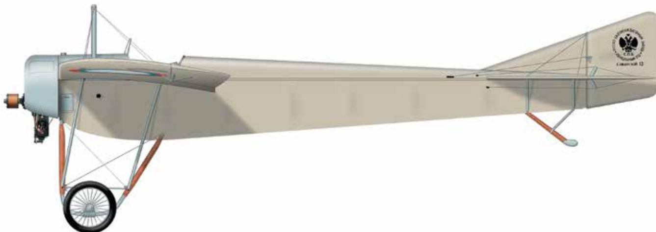
Одноместный спортивный самолет, создан И.И. Сикорским весной 1914 г. Конструкция — деревянная, с полотняной обшивкой. Во время Первой мировой войны применялся в двухместном варианте в качестве разведчика, позднее служил тренировочным самолетом в Эскадре воздушных кораблей.
