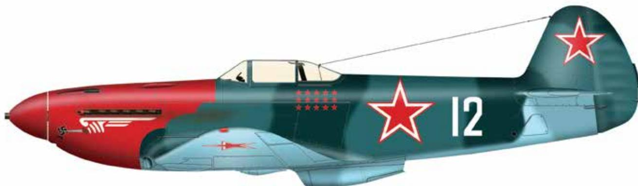
Наиболее совершенный из семейства поршневых истребителей А.С. Яковлева. В результате тщательной ревизии конструкции самолетов Як-1 и Як-9 создателям самолета удалось значительно снизить его вес, усовершенствовать аэродинамические формы. По маневренности Як-3 превосходил другие истребители, не уступая им в скорости при существенно менее мощном двигателе. После войны небольшой серией выпускали цельнометаллический Як-3 с мотором ВК-107.
