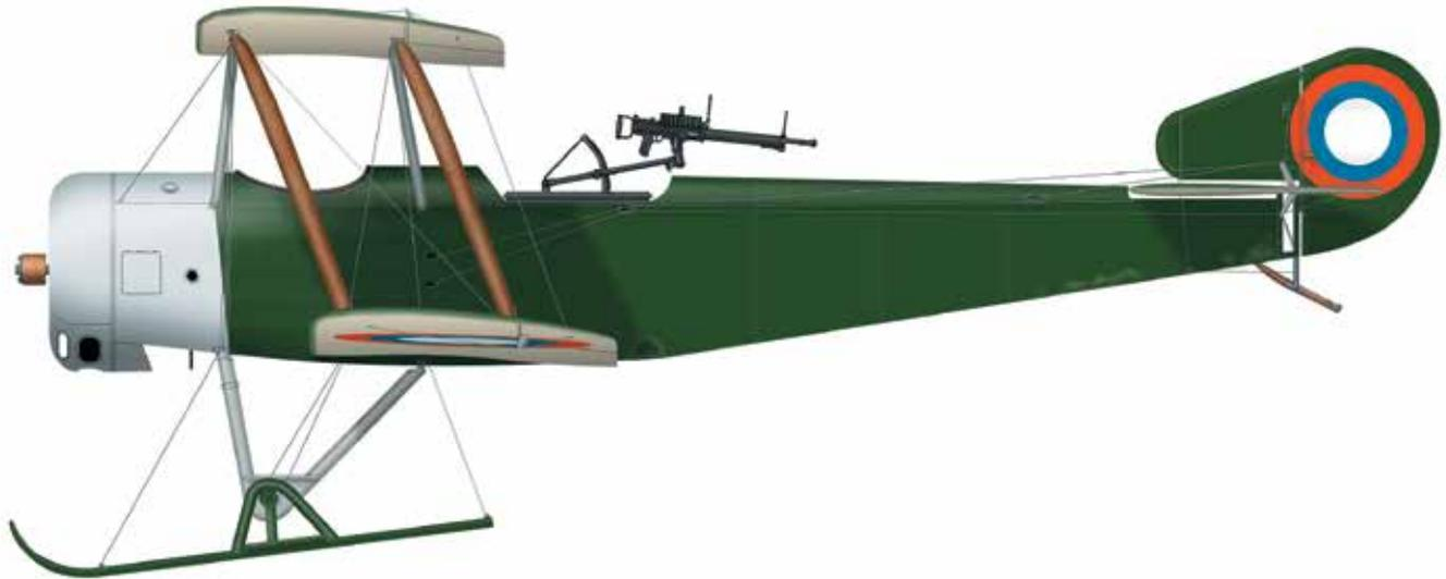
Двухместный английский самолет, создан конструктором Т. Сопвичем в конце 1915 г. Применялся в качестве истребителя, позднее — разведчика и легкого бомбардировщика. Имел типичную для тех лет схему, но обладал рядом новшеств, таких, как тормозные щитки на нижнем крыле и горизонтальный стабилизатор с регулируемым в полете углом установки. Из-за революции и развала петроградской авиапромышленности завод Лебедева сумел выпустить только 28 из 140 заказанных «Сопвичей».
