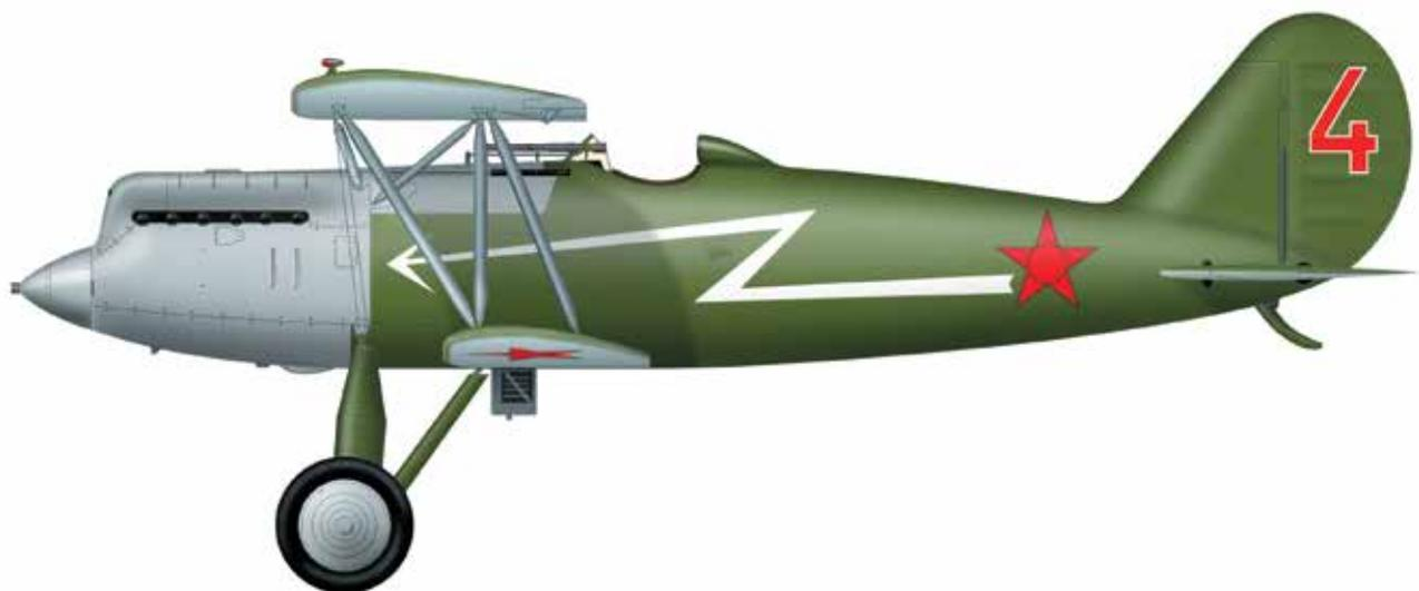
Истребитель Н.Н. Поликарпова, одноместный биплан деревянной конструкции с двигателем водяного охлаждения. В начале 30-х гг. был основным истребителем ВВС СССР. Находился на вооружении до 1935 г.
