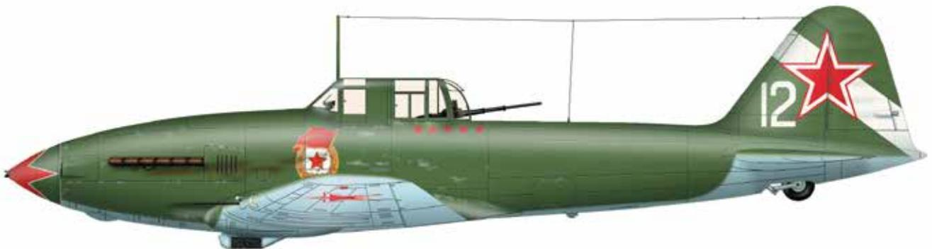
Развитие штурмовика Ил-2. Были уменьшены размеры, улучшены обтекаемость самолета и схема бронирования, усилено вооружение, установлен более мощный двигатель. Благодаря возросшей скорости и лучшей маневренности Ил-10 мог не только атаковать наземные цели, но и вступать в воздушный бой с противником. В 1951 г., после двухлетнего перерыва, производство самолета возобновили под маркой Ил-10М. Это было связано с ростом военной напряженности из-за войны в Корее.
