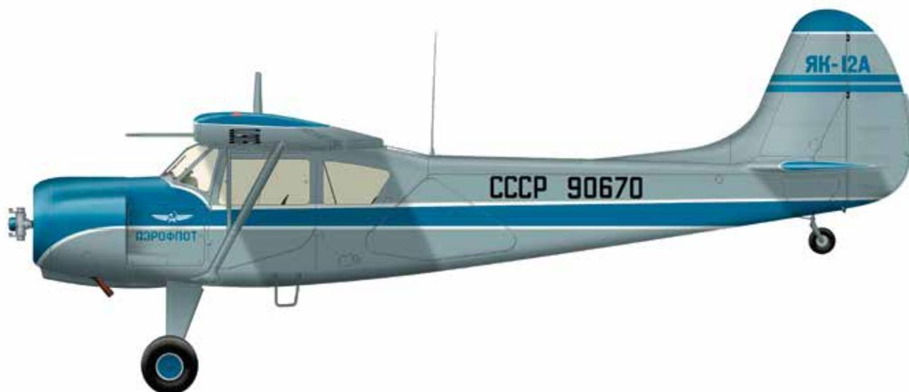
Выпущенный большой серией легкомоторный многоцелевой самолет, развитие линии АИР-6 — Як-10. Конструкция осталась смешанной, из дерева и металла, с полотняной обшивкой. Як-12 предназначался для использования в ВВС в качестве связного и санитарного самолета. На модификациях Р, М, А двигатель М-11ФР был заменен более мощным АИ-14Р, в конструкции шире применялся металл. Як-12А имел измененное крыло, увеличенные топливные баки, более комфортабельную кабину. Эти самолеты применялись и в ВВС, и в ГВФ.
