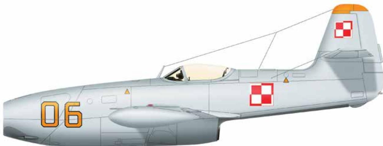
Развитие истребителя Як-15/17. Имел меньшие размеры, более мощный двигатель, цельнометаллическую конструкцию, крыло более тонкого профиля, катапультное кресло. Самолет обладал самыми высокими скороподъемностью и маневренностью среди реактивных истребителей своего времени.
