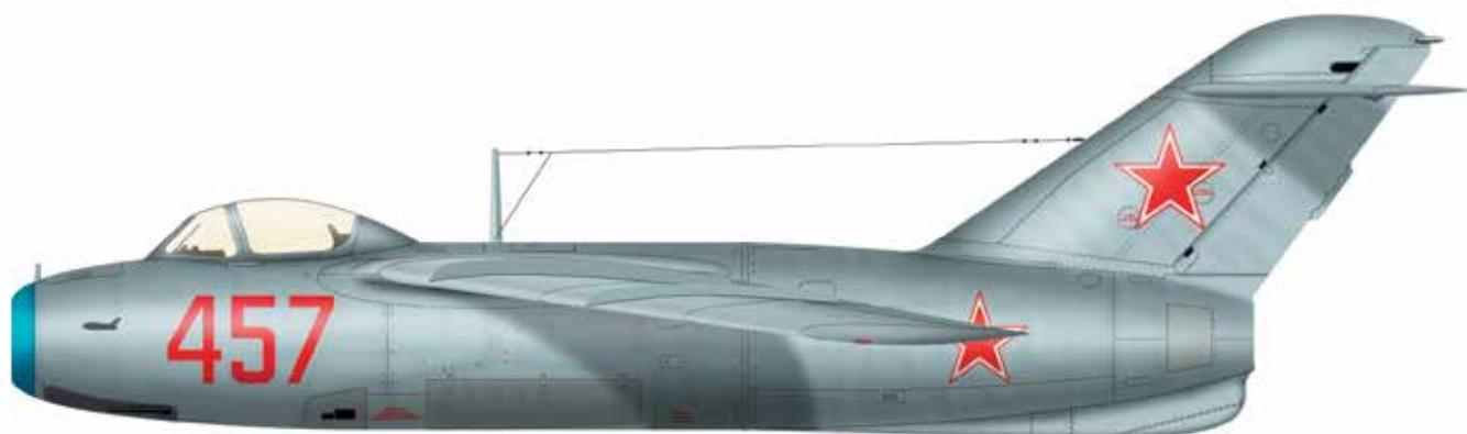
Единственный серийный реактивный истребитель ОКБ С.А. Лавочкина. Особенности самолета были верхнерасположенное стреловидное крыло и убирающееся в фюзеляж шасси. Так как основным турбореактивным двигателем в конце 40-х гг. стал РД-45 (ВК-1), а Ла-15 был спроектирован под другой двигатель, РД-500, самолет не долго находился в производстве и выпущен ограниченной серией.
