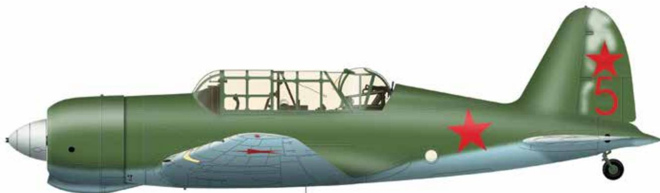
Первый серийный самолет конструкторского бюро П.О. Сухого, одномоторный легкий бомбардировщик, разведчик и штурмовик. Имел смешанную конструкцию с деревянным фюзеляжем и металлическим крылом. Мог нести бомбы как во внутреннем отсеке, так и на наружных подвесках. Применялся в начальный период Великой Отечественной войны, затем был вытеснен более скоростными самолетами типа Пе-2.
