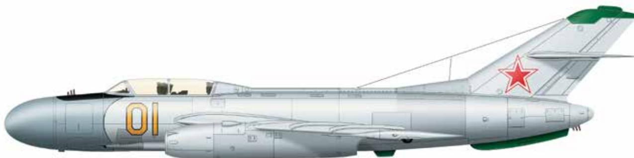
Первый отечественный всепогодный истребитель-перехватчик. Компоновка двигателей под крылом позволила установить в носовой части мощную по тем временам РАС и разместить большой объем топлива в фюзеляже, а стреловидная форма крыла — достичь околозвуковой скорости полета. Самолет находился в составе сил ПВО более 15 лет. Вариант Як-25Р представлял собой двухместный фоторазведчик с кабиной штурмана в носовой части фюзеляжа.
