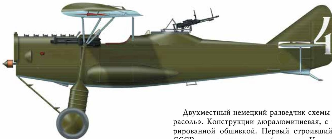
Двухместный немецкий разведчик схемы «парасоль». Конструкции дюралюминиевая, с гофрированной обшивкой. Первый строившийся в СССР цельнометаллический самолет. Находился на вооружении до начала 30-х гг.
