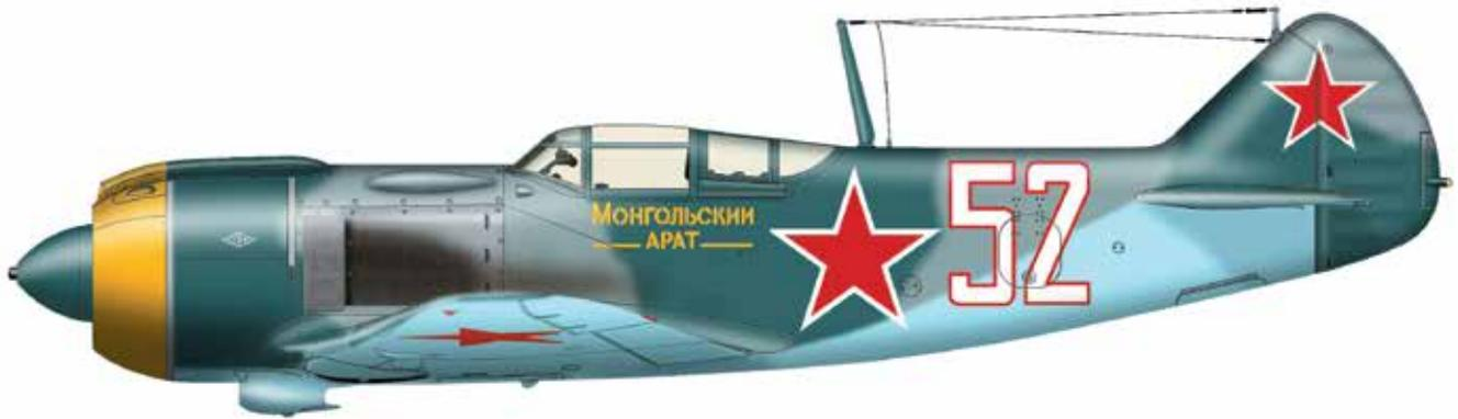
Переделка истребителя ЛаГГ-3 под двигатель воздушного охлаждения АШ-82, выполненная С.А. Лавочкиным в начале 1942 г. в связи с дефицитом моторов М-105. Самолет успешно прошел боевое крещение в небе над Сталинградом. В 1943 г. появилась модификация Ла-5ФН с увеличенной мощностью силовой установки. Ла-5/Ла-5ФН был самым распространенным советским истребителем с двигателем воздушного охлаждения периода Великой Отечественной войны.
