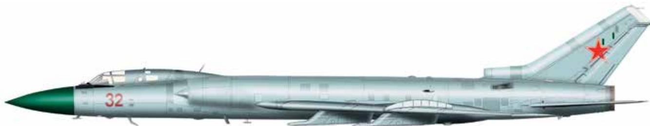
Двухместный перехватчик с большим радиусом действия, мощной РАС и ракетами «воздух-воздух» с тепловыми и радиолокационными системами наведения. Благодаря большому запасу топлива мог осуществлять продолжительное дежурство в воздухе. Самолет поступил на вооружение в 1965 г. и находился в ПВО до конца 80-х гг.
