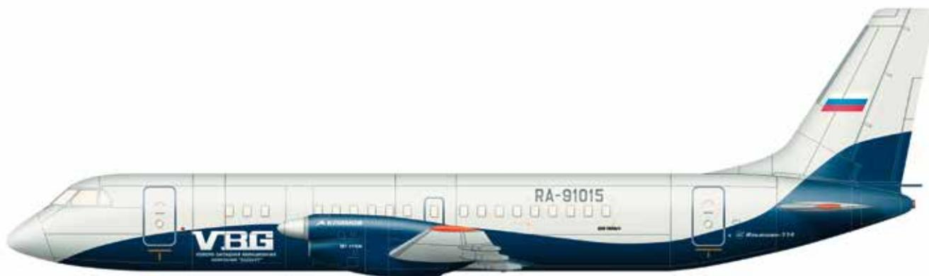
Двухмоторный турбовинтовой грузо-пассажирский самолет. Может использоваться на трассах с грунтовыми аэродромами. В его конструкцию заложен принцип автономности от наземных источников питания, что позволяет использовать Ил-114 на малооборудованных аэродромах, расширяя таким образом географию его применения. Имеется грузовой вариант Ил-114Т. Разработан в АК им. С.В. Ильюшина. Строится на авиазаводе в Ташкенте (Узбекистан). В апреле 1997 г. получен сертификат типа.
