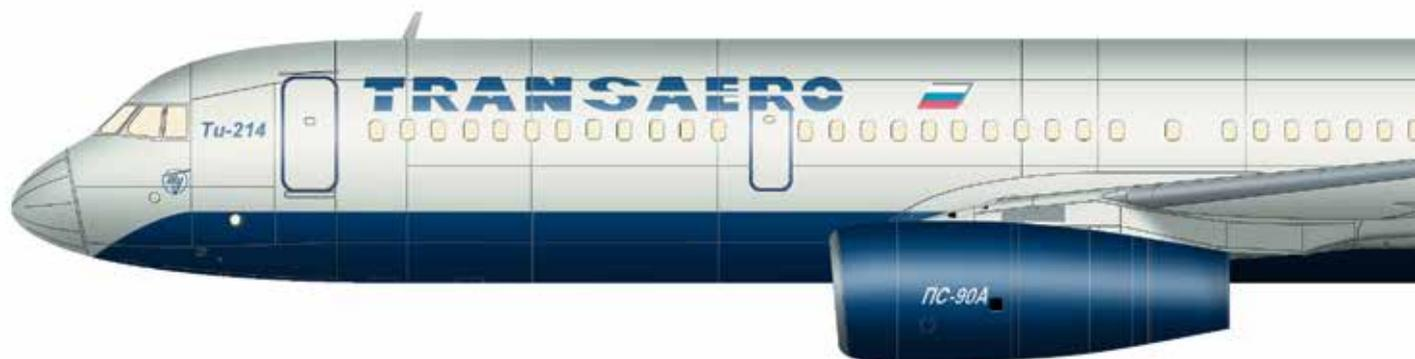
Среднемагистральный пассажирский самолет — усовершенствованный вариант Ту-204 с увеличенной взлетной массой. В декабре 2000 г. получен сертификат типа. Имеет грузовую модификацию, есть также вариант самолета-ретранслятора.
