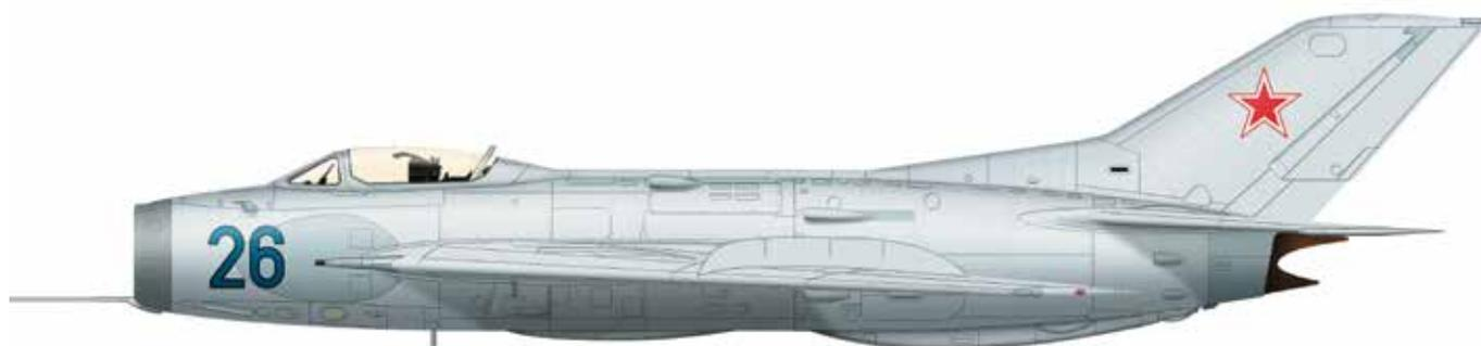
Первый в СССР серийный сверхзвуковой самолет. Преодоление звукового барьера обеспечивалось аэродинамикой (крыло стреловидностью 55° со специальным профилем) и двигателями с форсажной камерой. Впервые в практике отечественного самолетостроения был применен цельноповоротный горизонтальный стабилизатор вместо обычных рулей высоты. Самолет выпускали в вариантах фронтового истребителя (МиГ-19, МиГ-19С) и истребителя-перехватчика с радиолокатором (МиГ-19П, МиГ-19ПМ).
