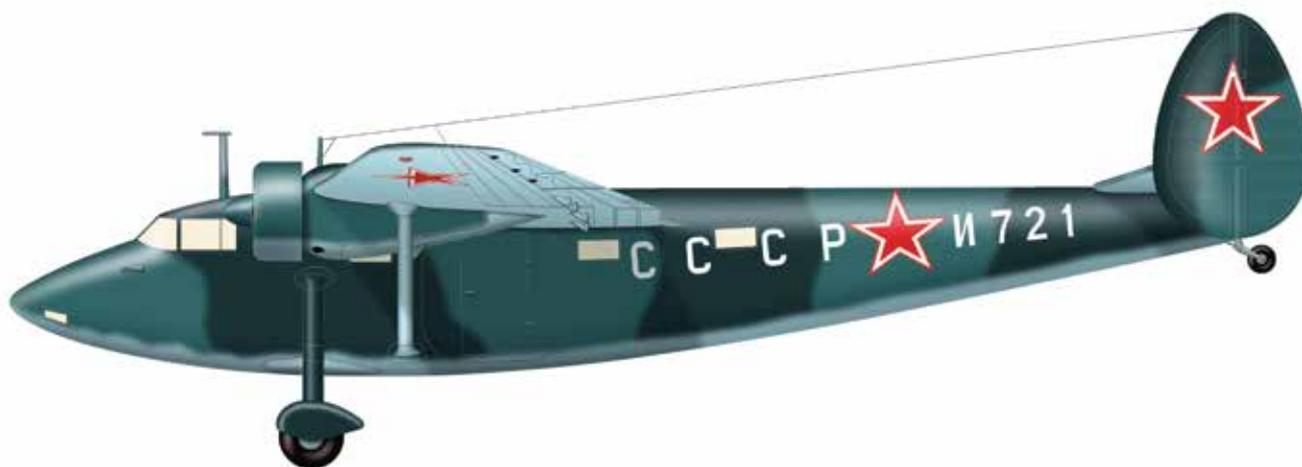
Легкомоторный транспортный самолет для обслуживания соединений действующей армии. Конструктор — А.Я. Щербаков. Использовался как грузовой, санитарный и десантный. Имел простую деревянную конструкцию и хорошо освоенные в производстве дешевые двигатели М-11. В санитарном варианте мог брать на борт 11 носилок с ранеными. Благодаря малой посадочной скорости мог приземляться на малых посадочных площадках.
