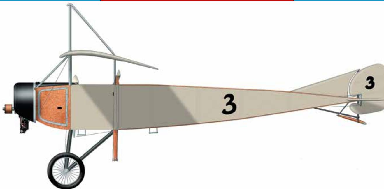
Французский двухместный моноплан, создан в 1913 г. специально для военных целей. Отличался от модели «Ж» приподнятым над фюзеляжем крылом; со временем эта схема получила название «парасоль». Такая компоновка обеспечивала превосходный обзор из кабины. Применялся на фронте как разведчик, с 1915 г. вооружался пулеметом и мог использоваться как истребитель. На самолете «Парасоль» П.Н. Нестеров совершил первый в мире воздушный таран.
