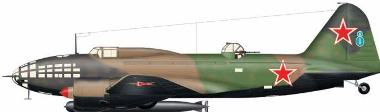
Глубокая модификация бомбардировщика ДБ-3. Была изменена форма носовой части фюзеляжа, усилено вооружение. Отказ от трубчатых лонжеронов крыла и другие изменения в конструкции упростили технологию и позволили применить плазово-шаблонный метод производства самолетов. Выпущенные серией более 5 тыс. экземпляров, Ил-4 составили основу дальнебомбардировочной авиации СССР в годы Великой Отечественной войны, а также применялись в качестве торпедоносцев на флоте.
