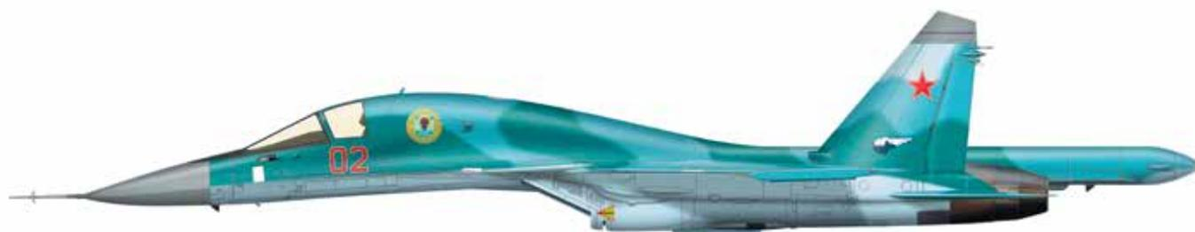
Двухместный фронтовой истребитель-бомбардировщик. Глубокая модификация Су-27 со значительно измененной конструкцией планера, увеличенным запасом топлива, новым комплексом бортового оборудования и вооружения. Может использоваться в воздушном бою, а также в ударных операциях. Разработан в ОКБ им. П.О. Сухого для замены фронтового бомбардировщика Су-24.
