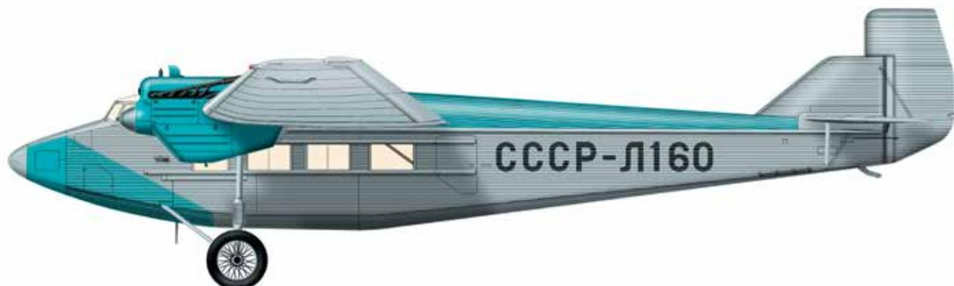
Первый серийный пассажирский самолет А.Н. Туполева, металлический моноплан с гофрированной обшивкой. В конструкции использованы агрегаты бомбардировщика ТБ-1. На первых самолетах устанавливали три американских двигателя Райт «Уирлуинд» мощностью 300 л.с., но большая часть машин имела два отечественных двигателя М-17. Прослужил в ГВФ до 1943 г.
