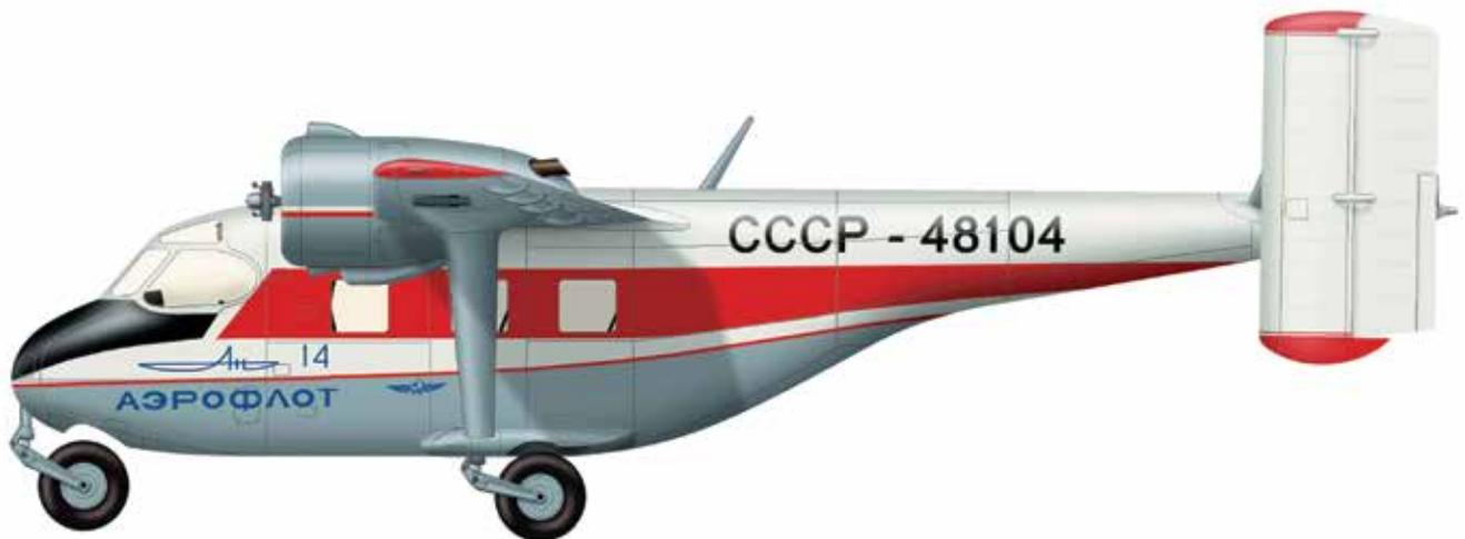
Многоцелевой самолет с коротким взлетом и посадкой, предназначен для перевозки пассажиров на коротких маршрутах и для сельскохозяйственных работ — опыления и подкормки посевов. Конструкция цельнометаллическая, крыло с мощной взлетно-посадочной механизацией, шасси неубирающееся, вертикальное оперение двухкилевое. Создан на замену биплану Ан-2.
