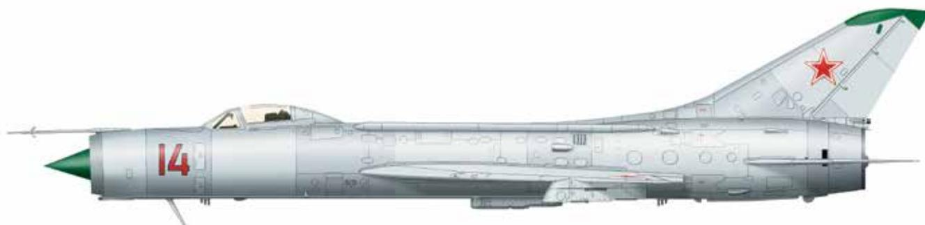
Развитие самолета Су-9. Су-11 имел более мощный радиолокатор, доработанный двигатель с возросшей тягой на форсаже и управляемые ракеты с улучшенными характеристиками. В связи с планами развертывания на Новосибирском заводе производства двухдвигательного перехватчика Як-28П объем выпуска Су-11 был небольшим.
