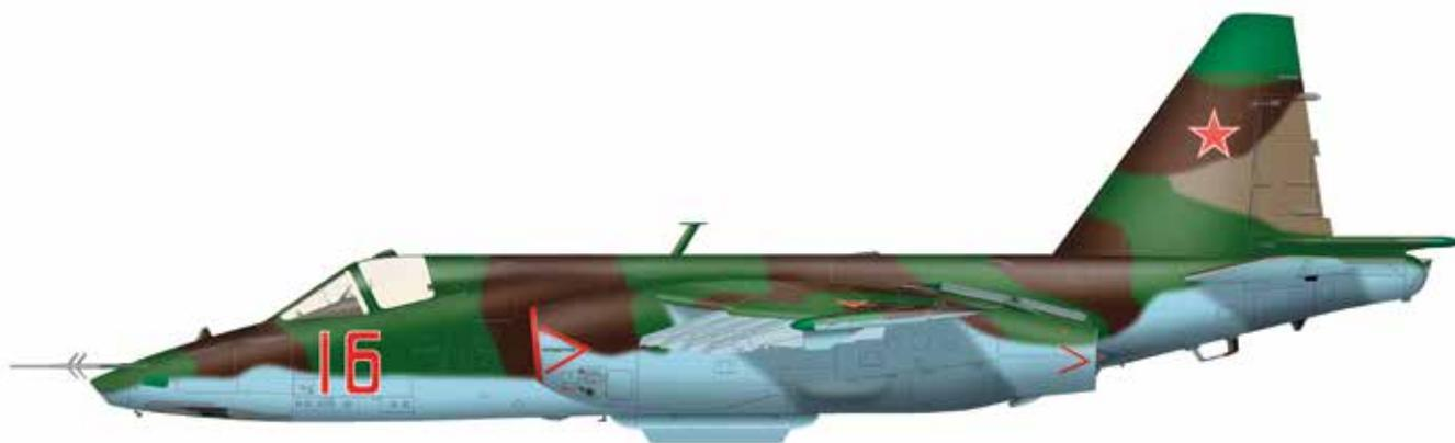
Самолет непосредственной поддержки войск, бронированный штурмовик. Титановой броней защищена кабина летчика, важнейшие агрегаты бортовых систем и оборудования. Для большей боевой живучести двигатели разнесены по бокам фюзеляжа, дублирована проводка систем управления самолетом. На заводе в Тбилиси стоили одноместные боевые Су-25, в Улан-Удэ — двухместные учебно-боевые Су-25УБ для ВВС и учебно-тренировочные Су-25УТГ для корабельной авиации.
