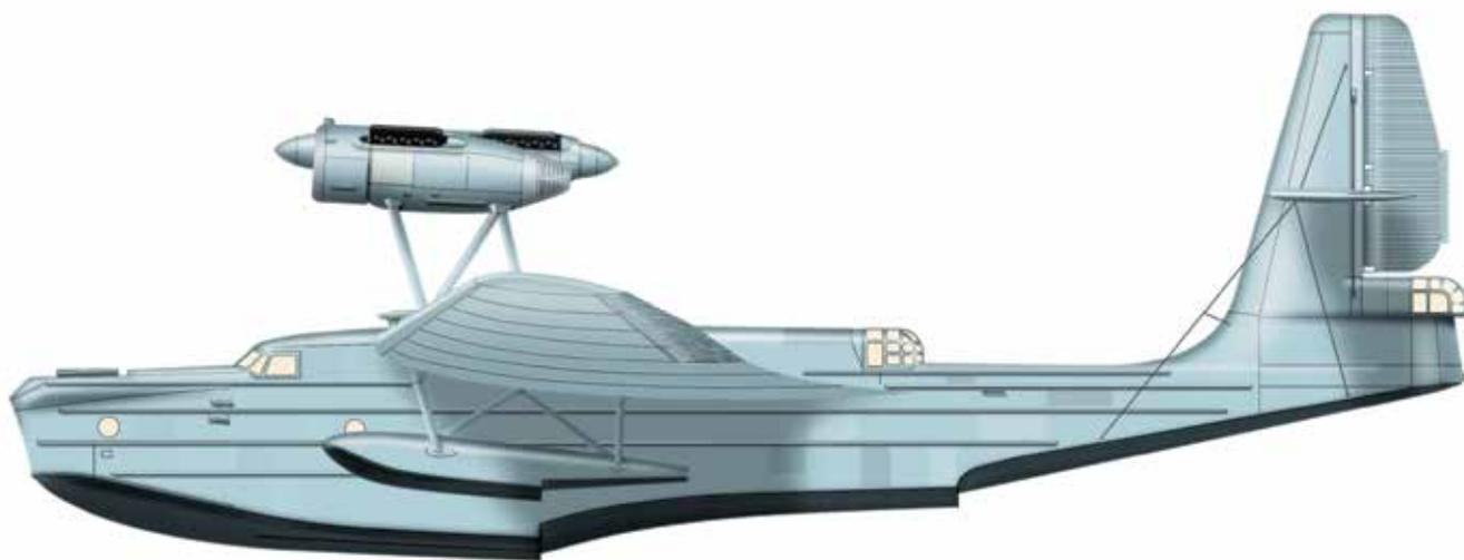
Трехмоторный дальний разведчик и бомбардировщик ОКБ Туполева был самым большим в СССР серийным гидросамолетом. Он имел цельнодюралевую конструкцию, мог нести значительную бомбовую нагрузку. Из-за затянувшихся испытаний к моменту серийного выпуска самолет устарел. Несколько принятых на вооружение экземпляров летали в авиации Черноморского флота.
