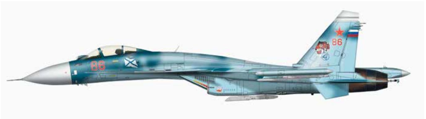
Одноместный корабельный истребитель. Разработан на базе самолета Су-27 в ОКБ им. Сухого для базирования на тяжелых авианесущих крейсерах с трамплинным взлетом и аэрофинишной посадкой. Имеет складывающиеся консоли крыла для уменьшения габаритов самолетов в ангарах корабля. Строился на заводе в Комсомольске-на-Амуре. В августе 1998 г. принят на вооружение ВВС России\*.
