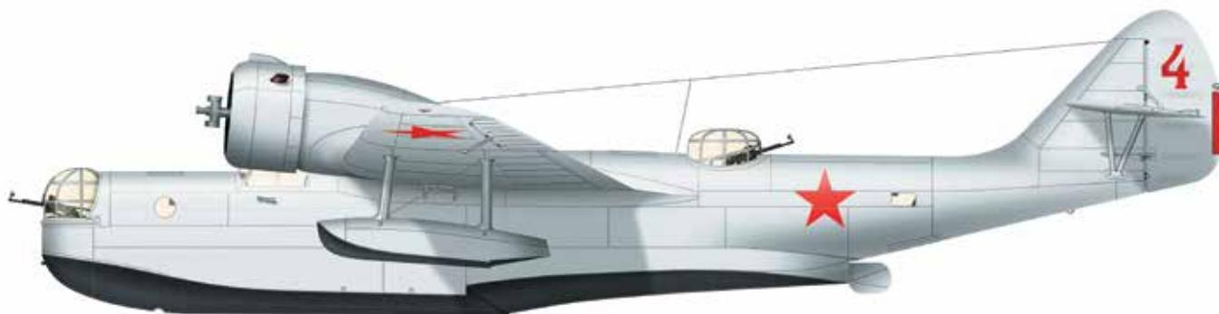
Скоростная двухмоторная цельнометаллическая летающая лодка, морской дальний разведчик и легкий бомбардировщик. Сконструирован под руководством И.В. Четверикова. Крыло типа «чайка», в местах перегиба которого расположены двигатели. Производство Че-2 велось недолго из-за эвакуации заводов в 1941 г.
