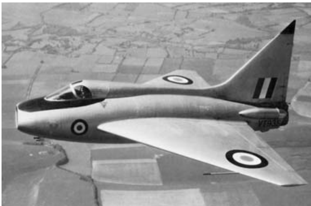
Экспериментальный Р.111 со снятыми законцовками крыла.
