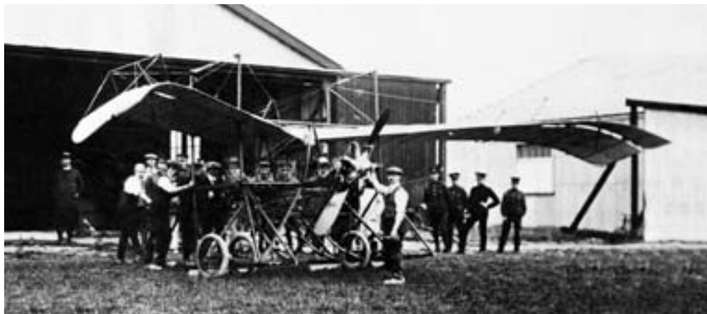
Моноплан Д.б. Для лучшей устойчивости концы крыла отогнуты вниз.
