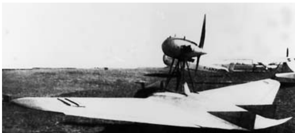
Мотопланер Ш.Фовеля AV-2. Из-за заметного влияния тяги винта на продольную устойчивость аппарата pilotировать его было сложно.
