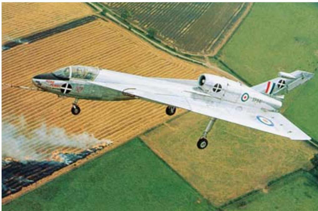
HR.115 предназначался для изучения характеристик треугольного крыла на больших углах атаки.
