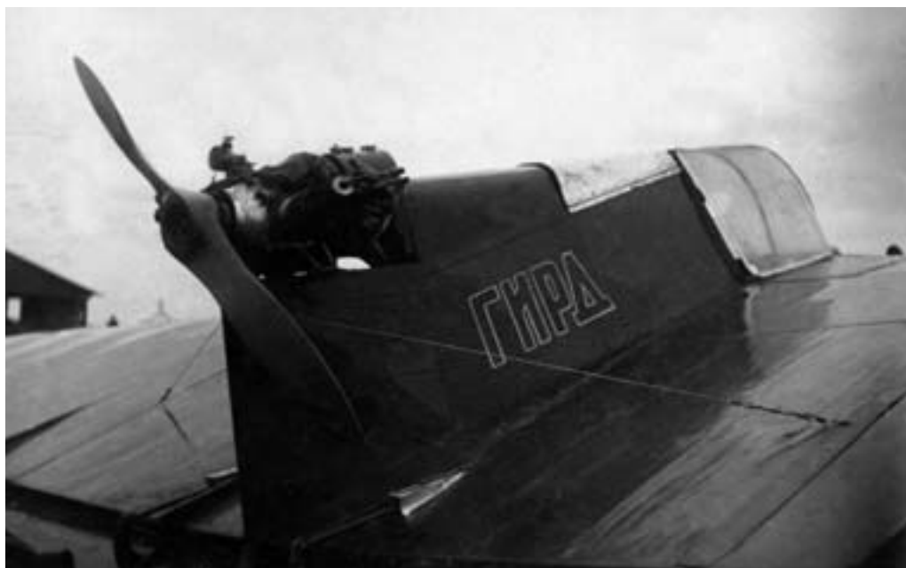
Из-за отсутствия ракетного двигателя РП-1 испытывался с обычным поршневым мотором.
