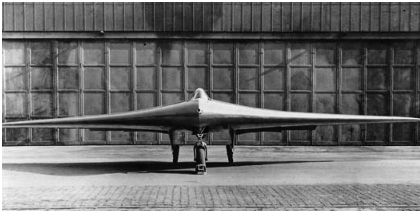
Но.IXV-1 — безмоторный прототип реактивного истребителя братьев Хортен.
