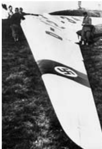
Планер Но.ІІІ отличался увеличенным удлинением крыла и измененной системой управления.
