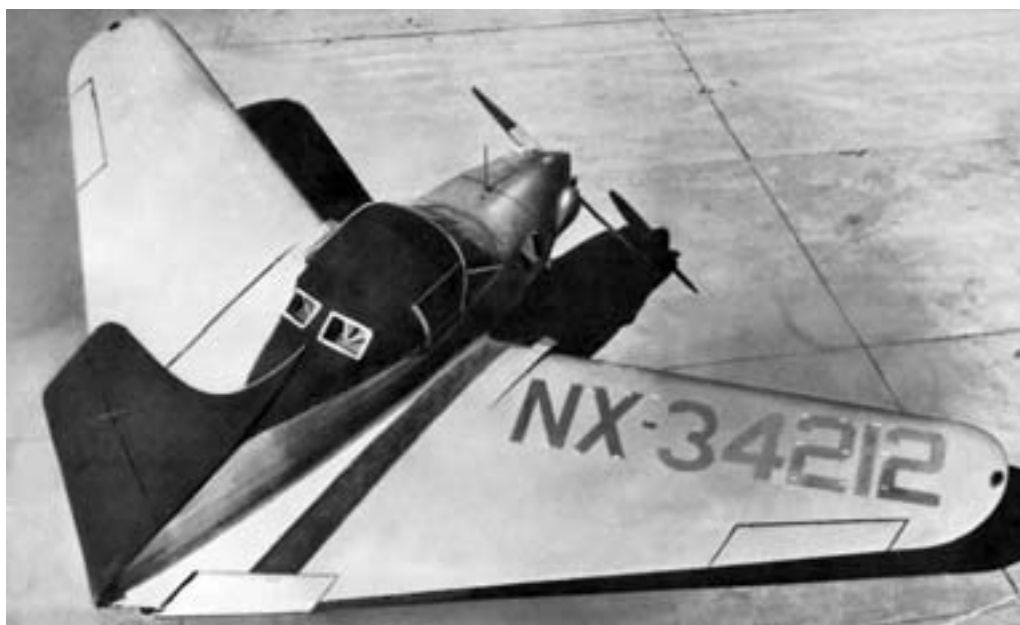
"Бесхвостка" с крылом обратной стреловидности "Маллард". По мнению ее конструктора, Д.Корнелиуса, опасность "штопора" на этом самолете была абсолютно исключена.
