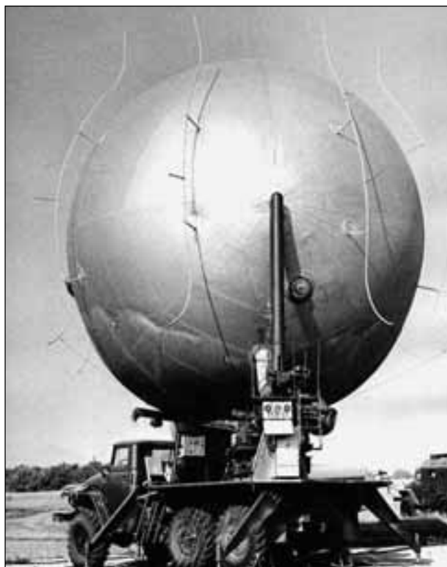
Привязной аэростат на удерживающем устройстве
