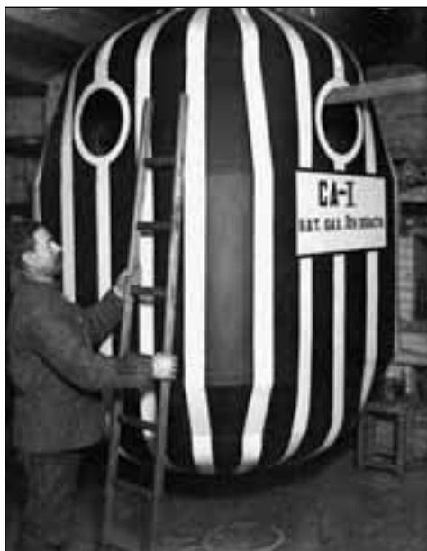
Первый вариант гондолы «Осоавиахим-1», не прошедший испытаний
