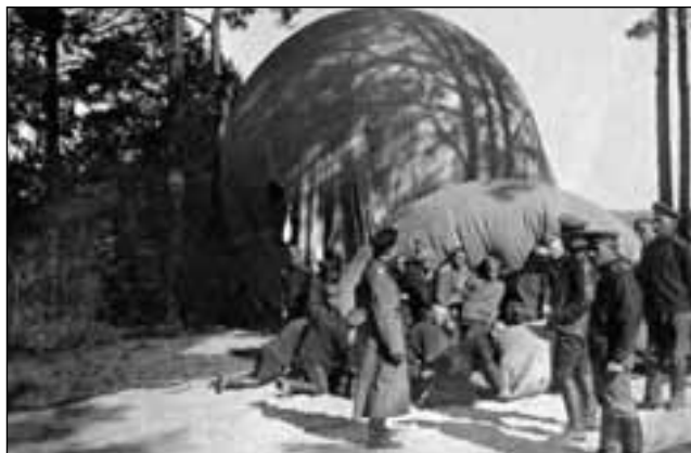
Переливание водорода из газгольдера в аэростат
