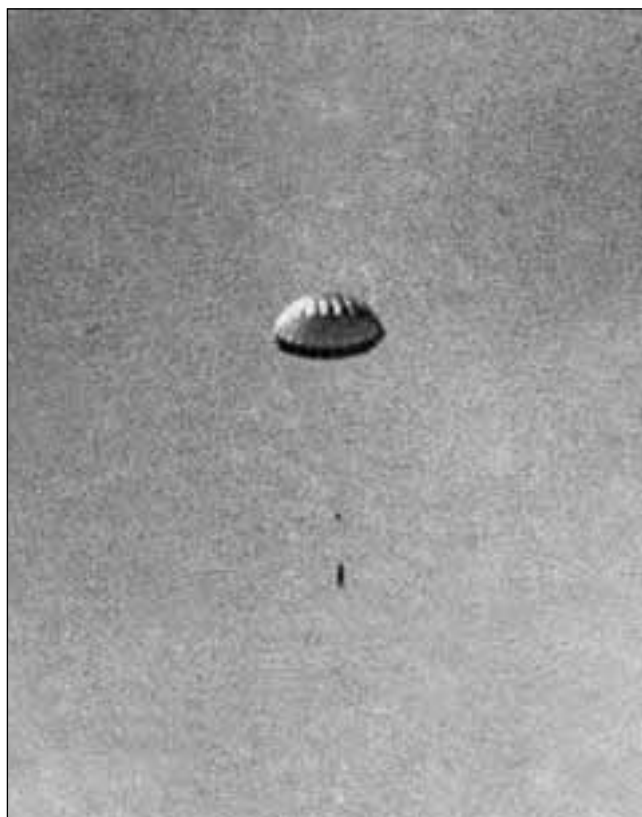
Испытательный сброс парашюта Жюкмесса с мешком балласта. 1917 г.
