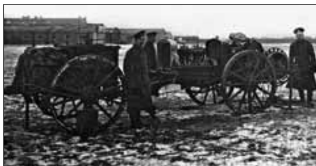
Конно-моторная лебёдка системы А.Е. Гарута образца 1908 г.
