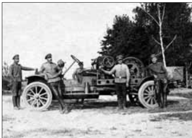
Автомобильная лебёдка «Адсудза» (1915 г.). На неё дополнительно установлен прожектор
