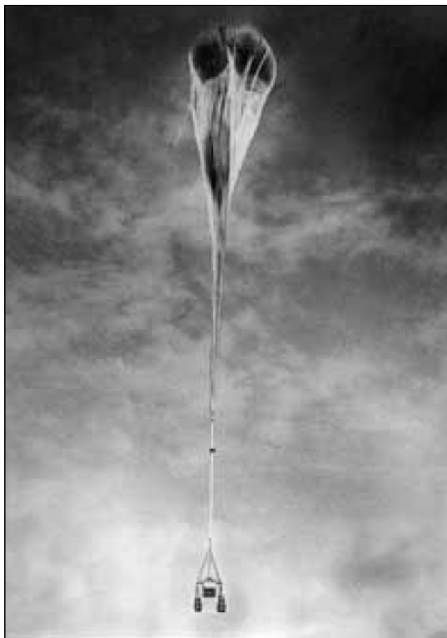
Автоматический аэростат-трансзонд АТ-ВМ
