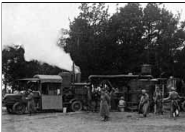
Силиколевая газодобывательная установка фирмы «Оксилит» на автомобильном ходу. Двинск, 23 марта 1917 г.
