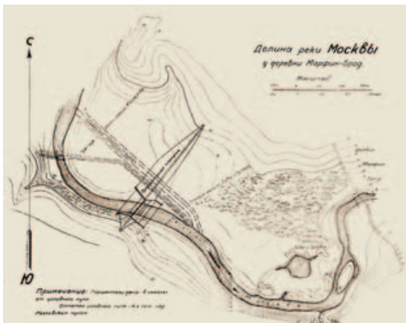
Рис. 52. План с обозначением плотин водохранилищ на р. Москве у д. Марфин Брод (Труды Комиссии по изысканиям новых источников водоснабжения г. Москвы. Вып. 1. Водоснабжение г. Москвы при помощи устройства водохранилищ в верховьях р. Москвы и на ее притоках. М., 1927. Черт. 4).
