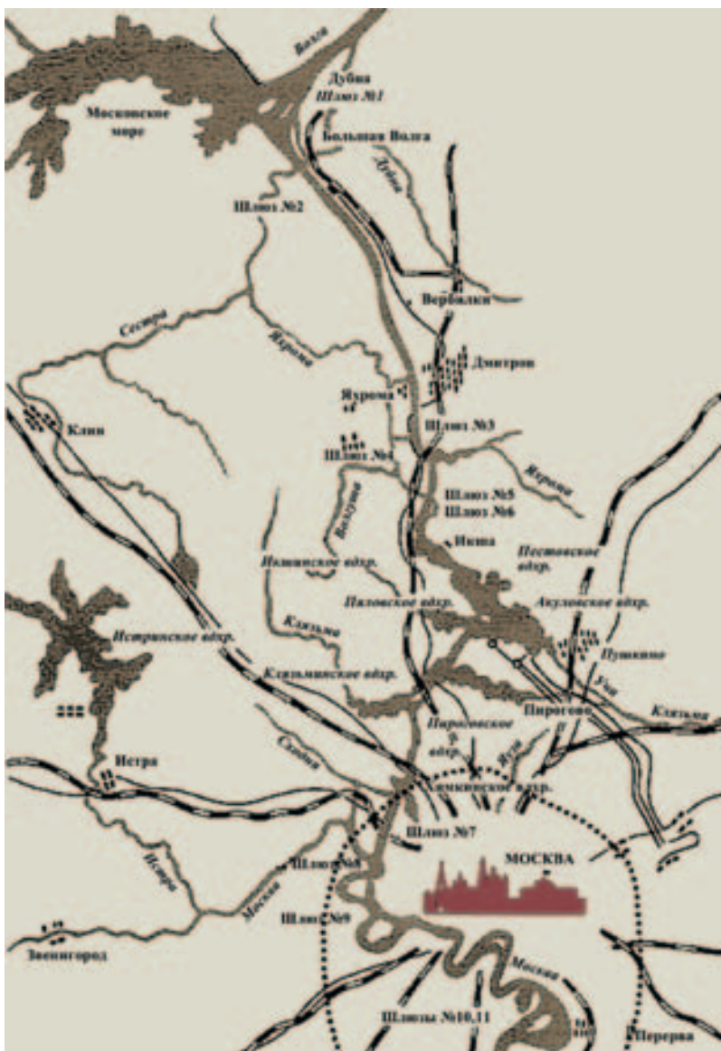
Рис. 19. Схема Канала им. Москвы (Канал Москва-Волга. 1932–1937. М.-Л., 1940. Вклейка, с изменениями).
