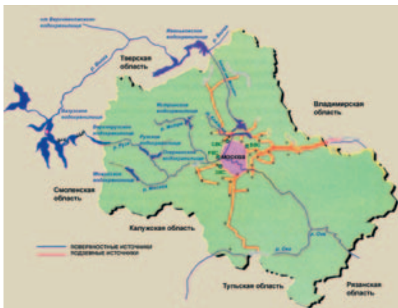
Рис. 21. Общая схема системы водоснабжения г. Москвы и Московской области (МосводоканалНИИпроект: в ракурсе истории. М., 1999. С. 95).
